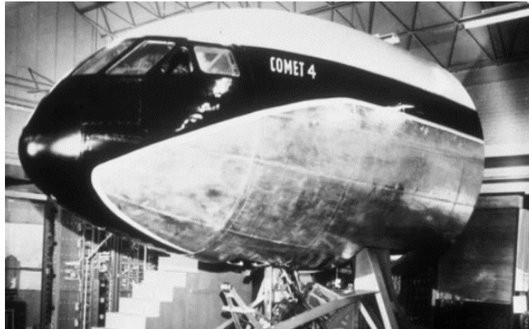
Fotoğraf 1.6. Comet IV Simülatörü (Anonim, Kasım 2013)
