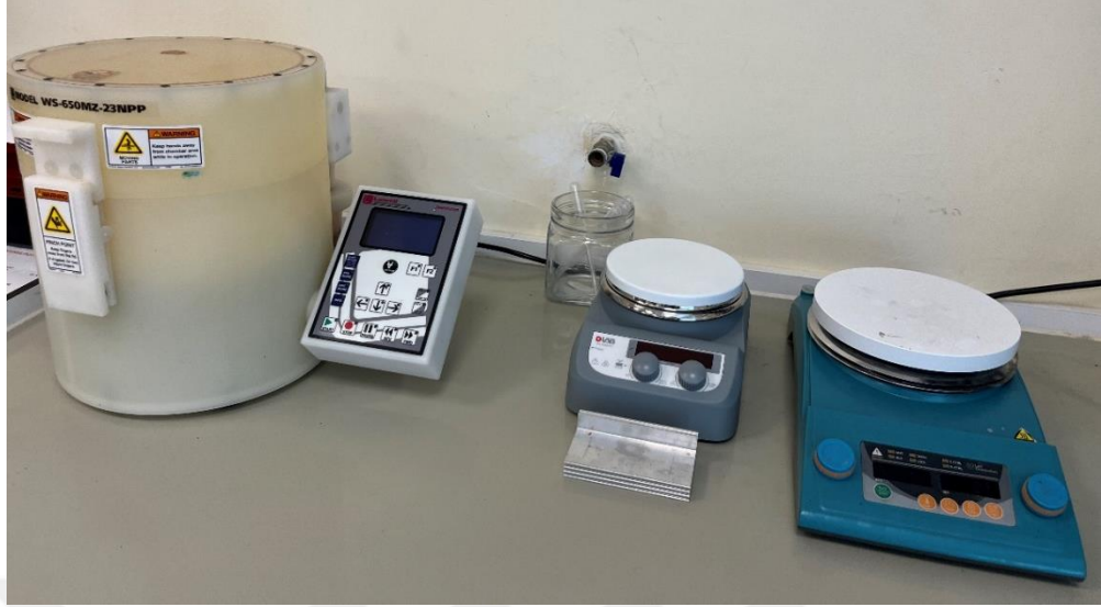
Şekil 4. 2. Bu çalışmada kullanılan döndürerek kaplama sistemi (sol) ve hot plate (sağ)
