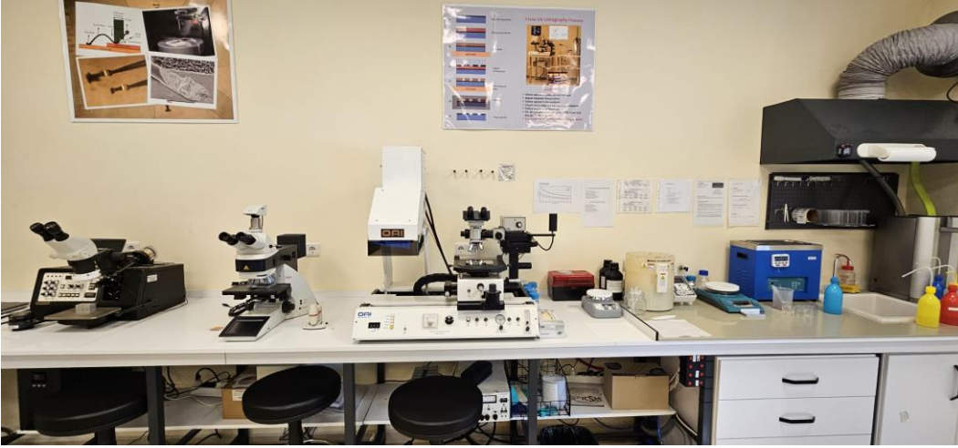
Şekil 4. 3. Tez çalışmasında kullanılan optik mikroskop ve UV fotolitografi sistemleri
