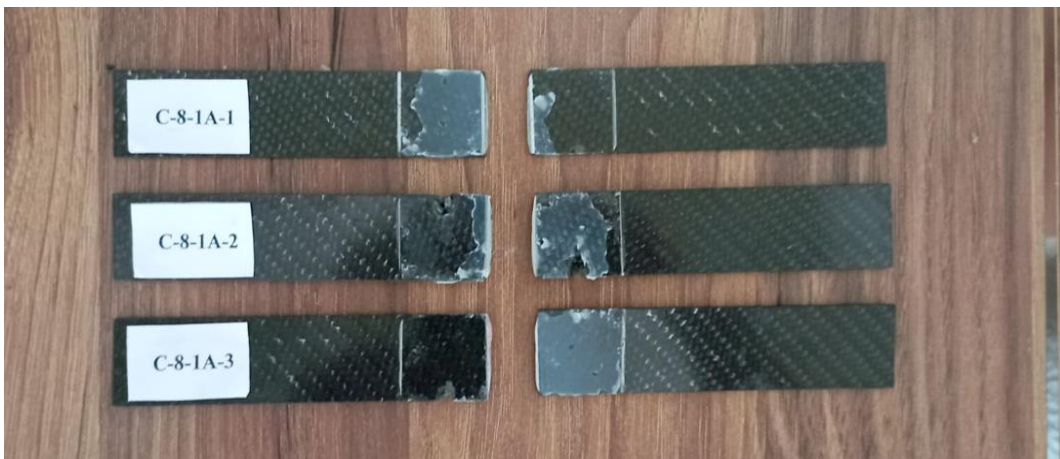
Şekil 3. 24. Eksenel darbeye maruz kalan kuru ortam CFRP numuneler
