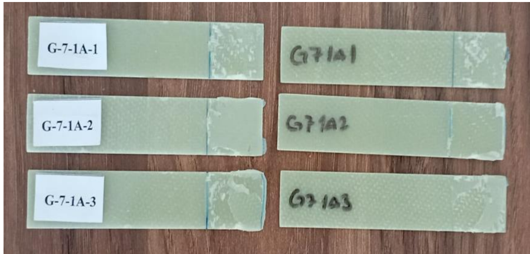
Şekil 3. 20. Eksenel darbeye maruz kalan 1 ay deniz suyunda bekletilen GFRP numuneleri
