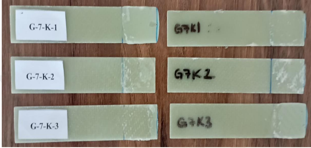
Şekil 3. 19. Eksenel darbeye maruz kalan kuru ortam GFRP numuneleri
