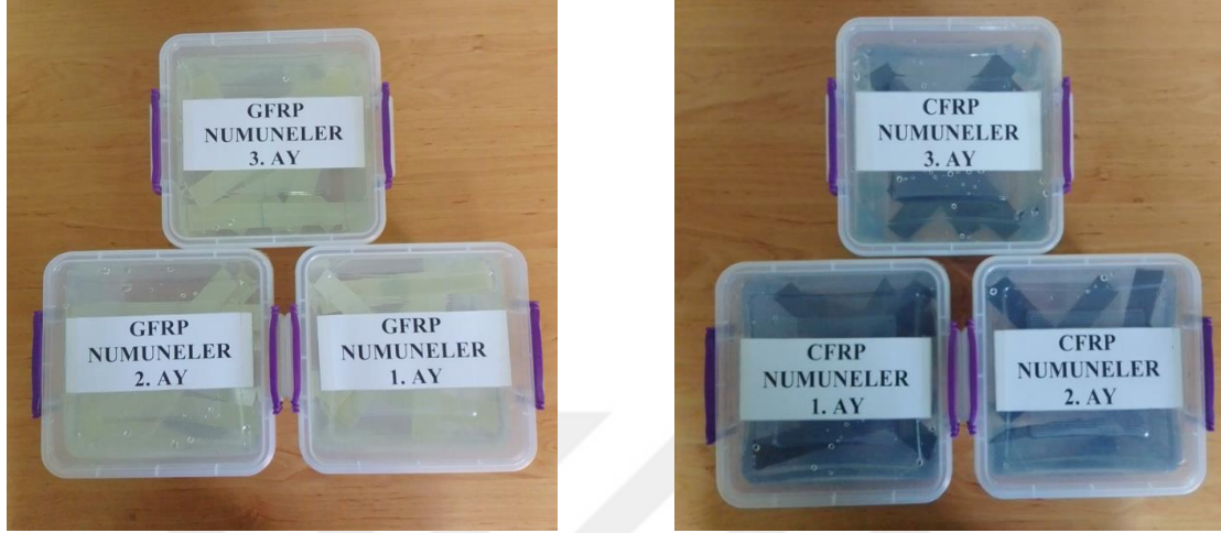
Şekil 3. 13. GFRP ve CFRP numunelerinin deniz suyu bekletilmesi
