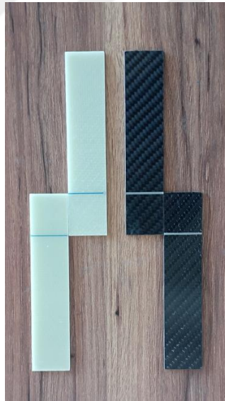
Şekil 3. 6. Yapıştırma öncesi numunelerin hazırlanması
