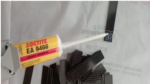
Şekil 3. 8. Numunelere Loctite Hysol-9466 yapıştırıcının uygulanması
