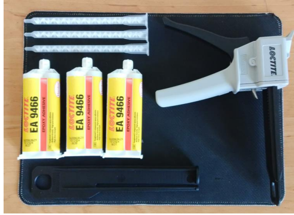
Şekil 3. 7. Çift kartuşlu manuel uygulama tabancası ve Loctite Hysol-9466
