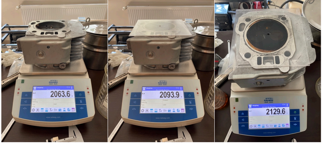
Şekil 5. 11. Standart motor yanma odası hacmi
