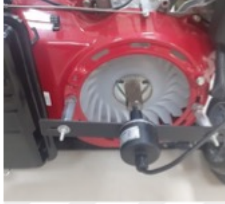
Şekil 5. 9. Krank mili enkoder bağlantısı
