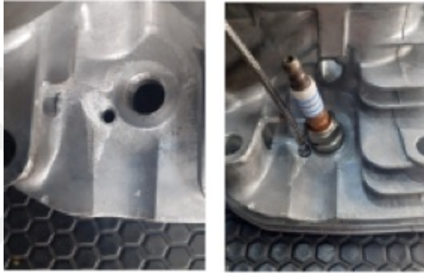
Şekil 5. 10. Silindir kapağı delme ve montaj işlemi
