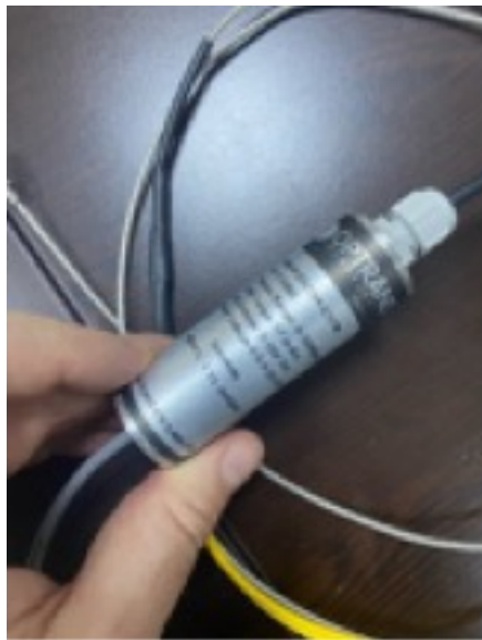
Şekil 5. 8. OPTRAND fiber-optik basınç sensörü
