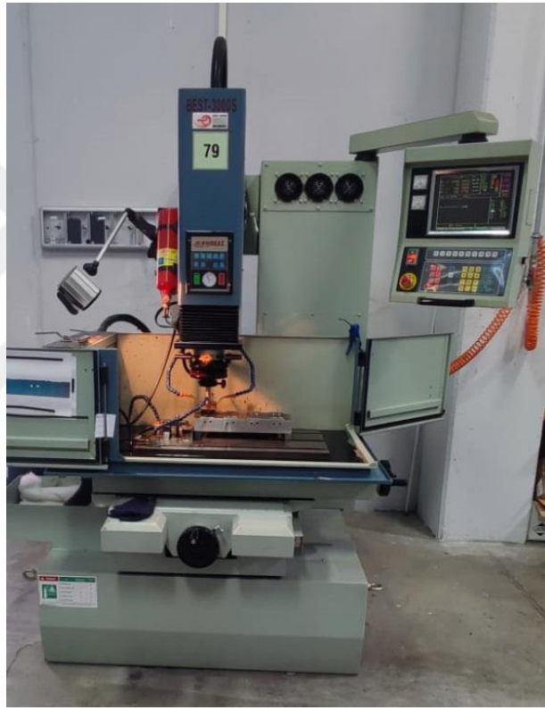
Şekil 7.24. Revizyonlu Kalıp Üretimi Sırasında Kullanılan Dalma Erozyon.
