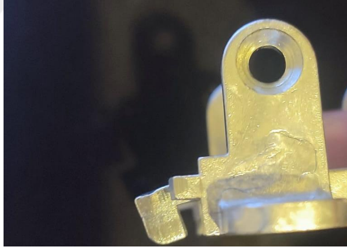
Şekil 8.9. Tırnak Kısımında Meydana Gelen Deformasyon
