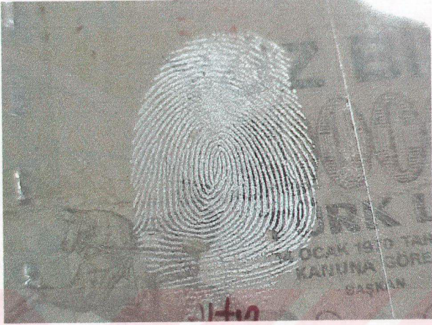
Şekil 3.8. Parlaklık araştırmasından sonra vakum metal çöktürme tekniği uygulaması
