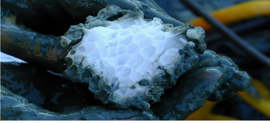
Şekil 2.1 : Çıkarılmış gaz hidrat numunesi (Al-Khatib, 2020).
