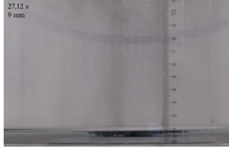
Şekil 3.18 : 4D girdap önleyici cihaz durgun hal kritik zaman ve yükseklik.
