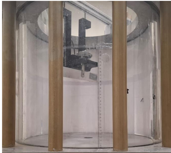
Şekil 3.12 : Tankın içerisine yerleştirilmiş karıştırıcı.
