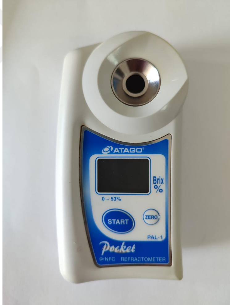
Şekil 3.2 Suda çözünabilir kuru madde miktarı ölçüm işlemleri
