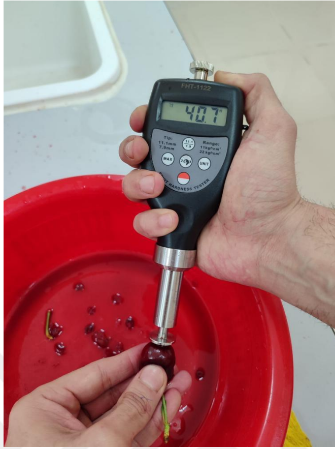
Şekil 4.6 Meyve eti sertliği ölçüm işlemi
