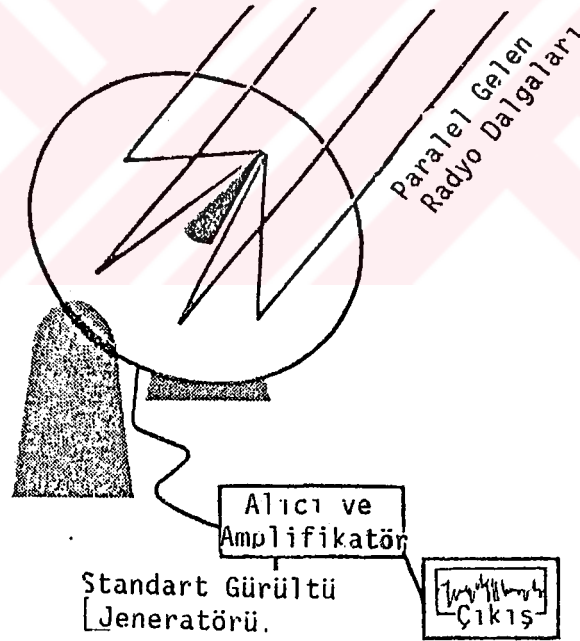
Şekil 24. Radyo teleskopların ana parçaları
