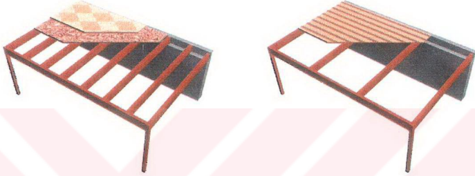
Şekil 3.16 Kirişler ve ahşap tabliye [Ching, 1991]
