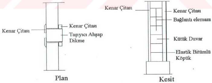
Şekil 3.1. Dikmeli kütüklerde birinci yapım yöntemi
