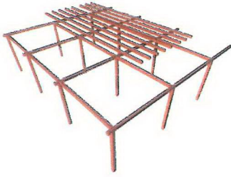
Şekil 3.17. Dikme üstü kiriş (tek katlı), [Avlar, 2003]
