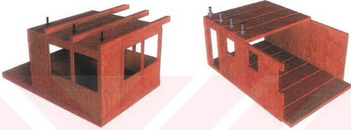
Şekil 3.8. Küçük ve geniş taşıyıcı paneller [Avlar, 2003]
