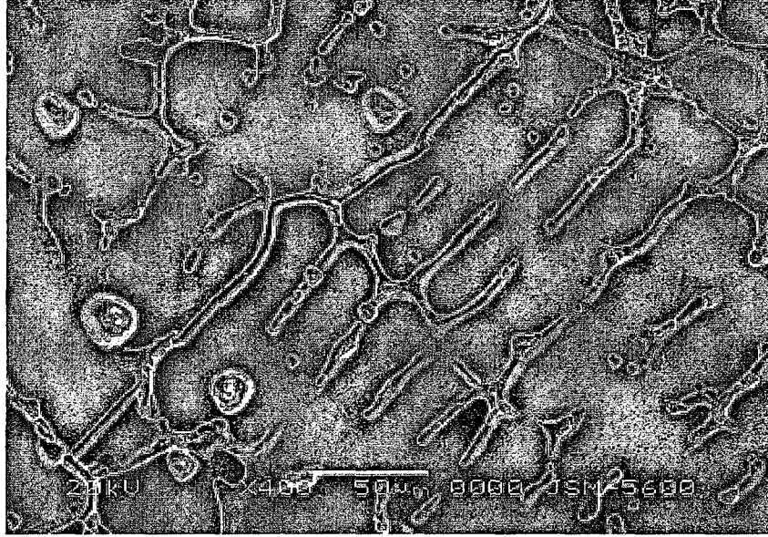
Şekil 3.2. 1100°C de 24 saat ısıl işlem görmüş numunede dendrit yapılar
