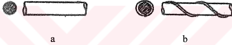
Şekil 3.2. EPS - bloklı çelik donatılı beton taşıyıcı duvar sisteminde taşıyıcı duvarlarda kullanılan çelik çubuklar [3] a) Normal yuvarlak çelik b) Nervürlü tor çelik
