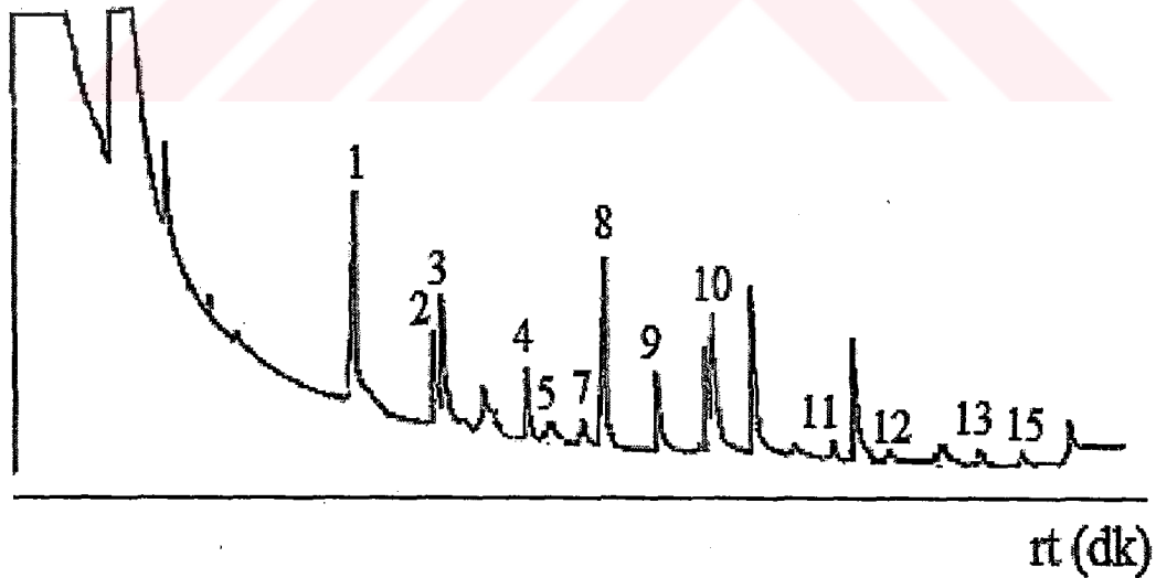
Şekil 3.22 Acılık Deresi dip çamuru örneğinin geri eks. yapılmadan önerilen türetme metodu ile alınan GC kromatogramı, 1. metilamin, 2. dipropilamin, 3. piperidin, 4. morfolin, 5. histamin, 7. anilin, 8. benzilamin 9. p -toluidin, 10. benzimidazol, 11. aminofenol, 12. piperazin, 13. 1-naftilamin, 15. 1,2-fenilendiamin.
