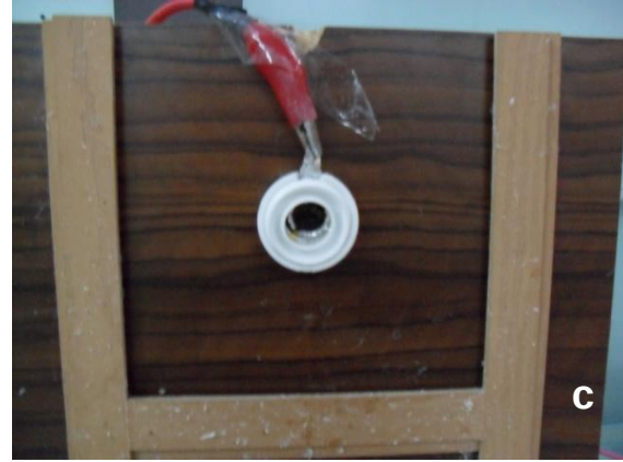
Şekil 3.1 Elektro-eğirme a) sisteminin görüntüsü, b) iğne-toplayıcı levha görüntüsü, c) toplayıcı levha görüntüsü
