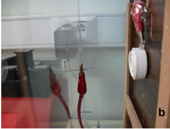
Şekil 3.1 Elektro-eğirme a) sisteminin görüntüsü, b) iğne-toplayıcı levha görüntüsü, c) toplayıcı levha görüntüsü
