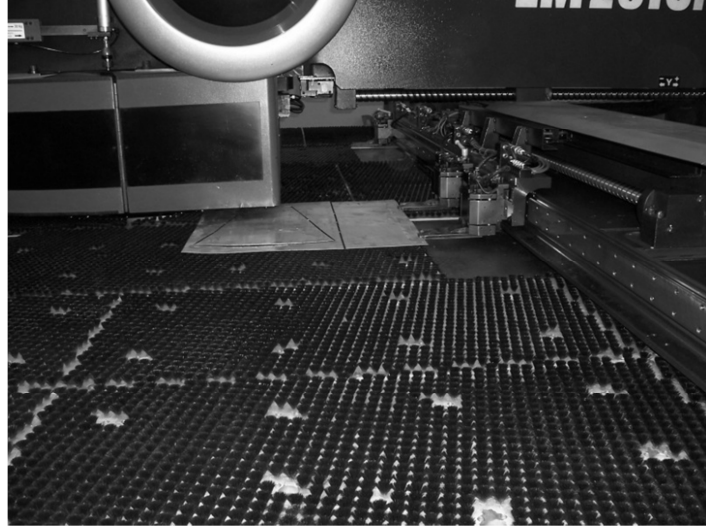
Şekil 4.10: CNC Punch aletinde baca bağlantı ekipmanının kesimi
