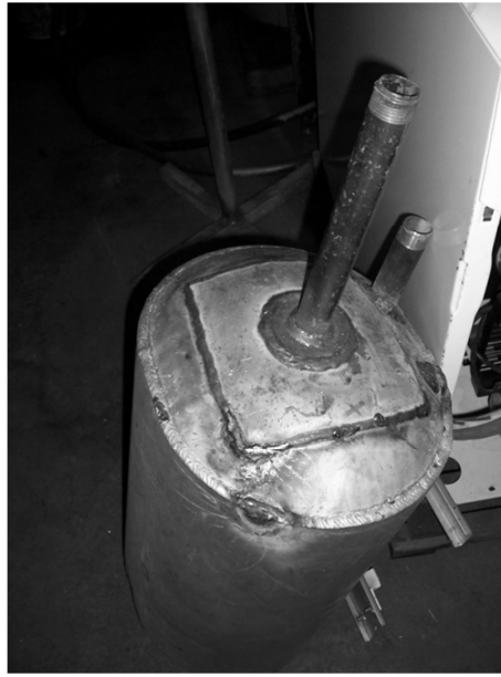
Şekil 4.12: Sabit debi besleme tankı imalat görüntüsü
