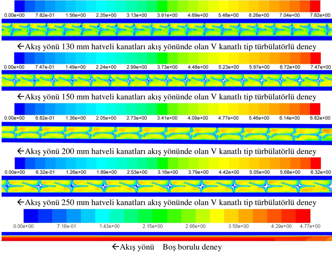
Şekil 7.22 : 3,92 m/s giriş hızında yapılan deneylerin kanatları akış yönünde olan V kanatlı tip türbülantörler için hız dağılımı
