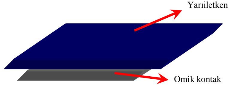
Şekil 2.9. Metal-yarıiletken kontakın şematik yapısı
