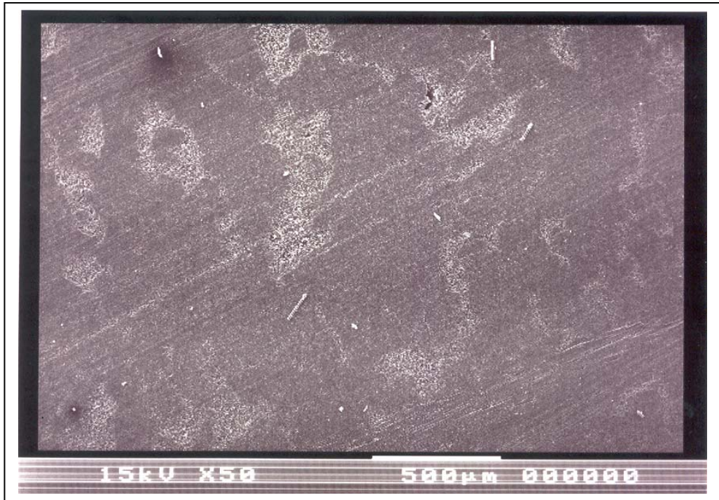
Şekil 7.12 Karbon Fren Diski 50X SEM Görüntüsü
