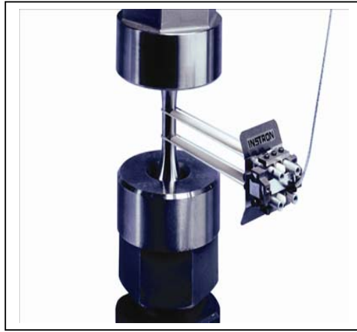
Şekil 6.17 Yüksek Sıcaklık Mekanik Test Düzenegi
