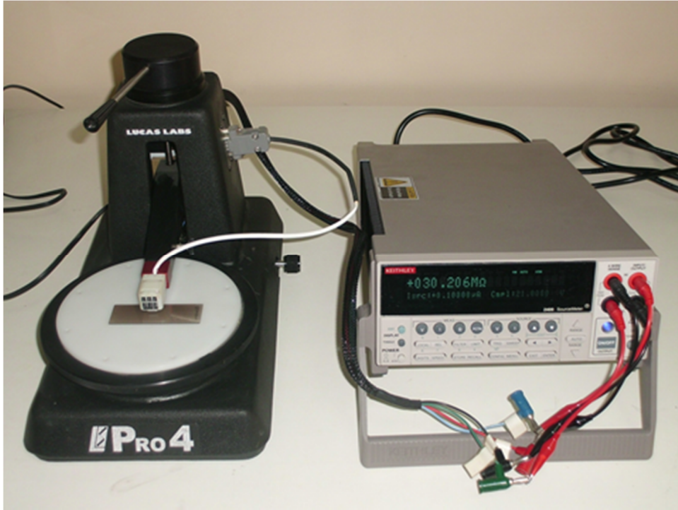
Şekil 3.6. Dört Nokta Yönteminin Cihazları [soldaki: Lucas Labs Pro4 ve sağdaki: Keithley 2400 Sourcemeter (güç kaynağı)]
