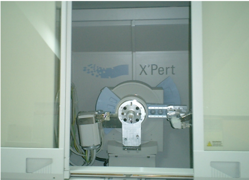
Şekil 3.3.b. Philips X'Pert PRO marka X- ışını difraksiyonu cihazının iç görüntüsü
