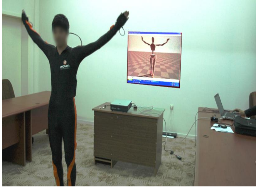
Şekil 3.22. XSens Moven hareket yakalama sistemi düzeneği
