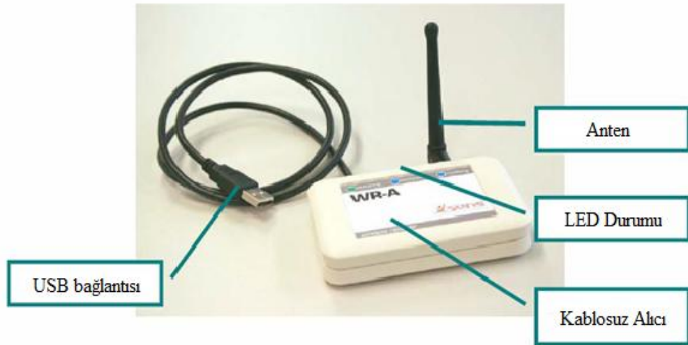
Şekil 2.8. Xbus Master ile bilgisayar arasındaki veri trafiği için kablosuz alıcı [78]
