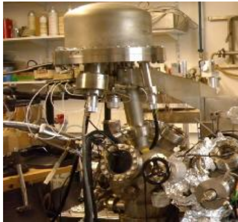
Şekil 3.8. XPS ölçüm sistemi ve şematik gösterimi
