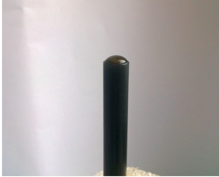
Şekil 3.2. Camsı karbon elektrot üzerine tutuklanmış çoklu enzim sistem
