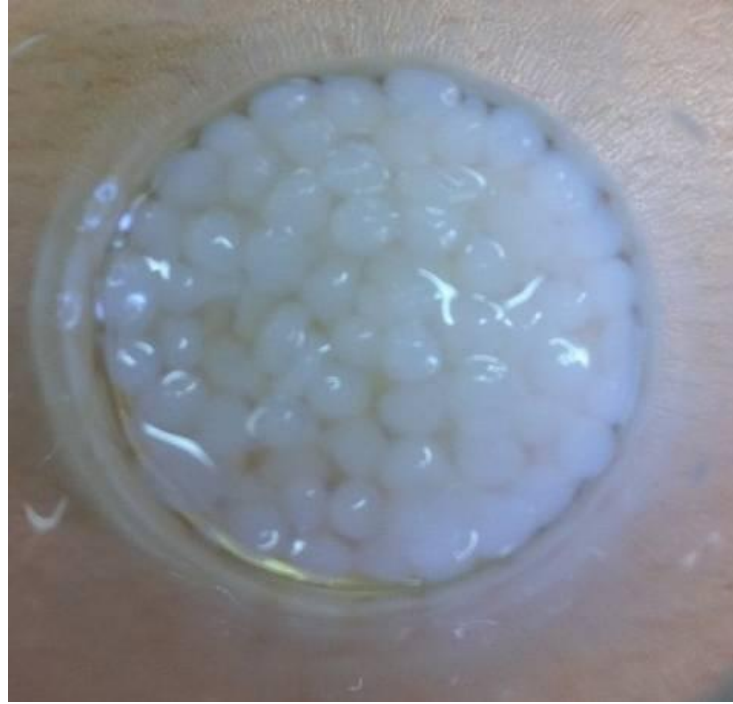
Şekil 4.6 Kitosan boncuklara pullulanaz adsorbsiyonu
