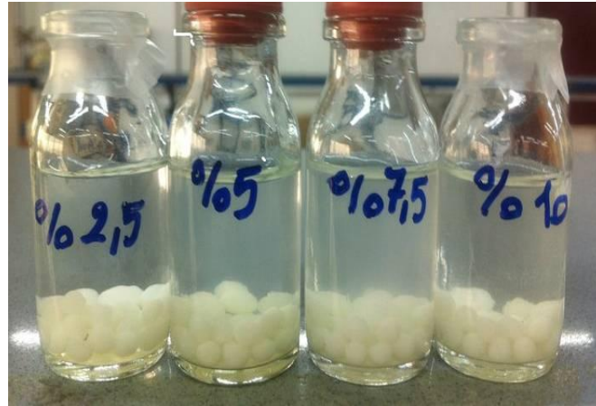
Şekil 4.7 Kitosan Boncuklara Pullulanaz Çapraz Bağlama
