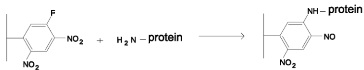
Şekil 3.10 3-Floro-4,6-dinitrofenil fonksiyonel grubu taşıyan polimerlere enzim bağlanması
