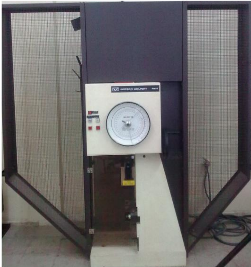
Şekil 4.9. Çentik darbe deneyi cihazı
