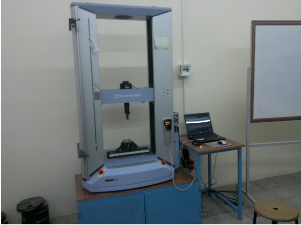
Şekil 4.10. Bilgisayar destekli eğme deneyi cihazı
