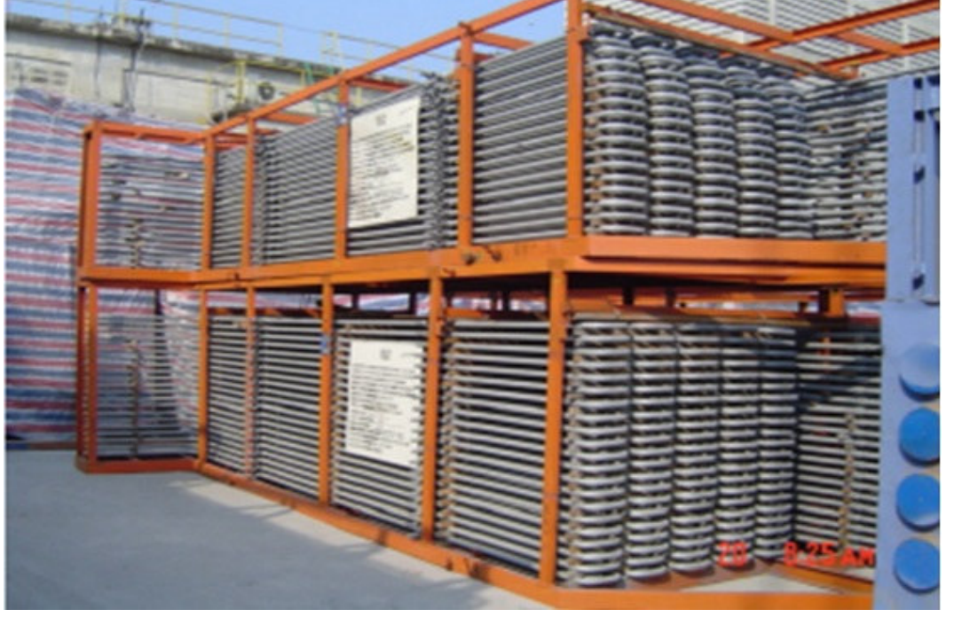
Şekil 3.6 SP Kazan Serpantin Boruları
