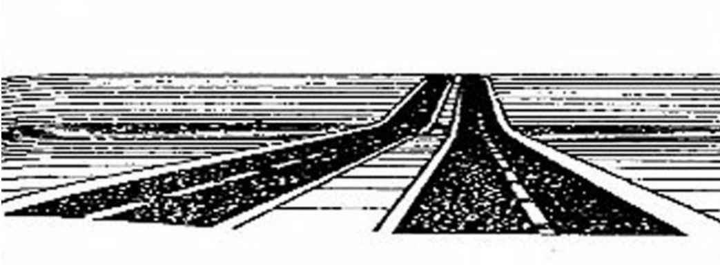
Şekil 44: Güzergahtaki yatay ve düşey kavislere örnek: Düşey kavisler üzerinde kısa kırıklıklar (Doğru) (Akdoğan 1970).
