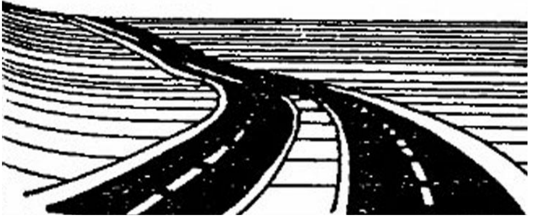
Şekil 48: Güzergahtaki yatay ve düşey kavislere örnek: Yatay kavisler üzerinde kısa düşey kavisler hatalı bir perspektif ve emin olmayan bir trafik oluşturur. (Yanlış) (Akdoğan 1970)
