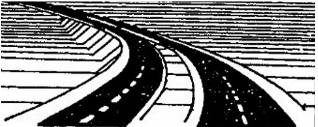
Şekil 49: Güzergahtaki yatay ve düşey kavislere örnek: Yatay ve düşey kavislerin en ideal kombinasyonu(Doğru) (Akdoğan 1970)
