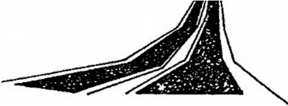
Şekil 45: Güzergahtaki yatay ve düşey kavislere örnek: Düşey kavisler üzerinde kısa kırıklıklar (Yanlış) (Akdoğan 1970).
