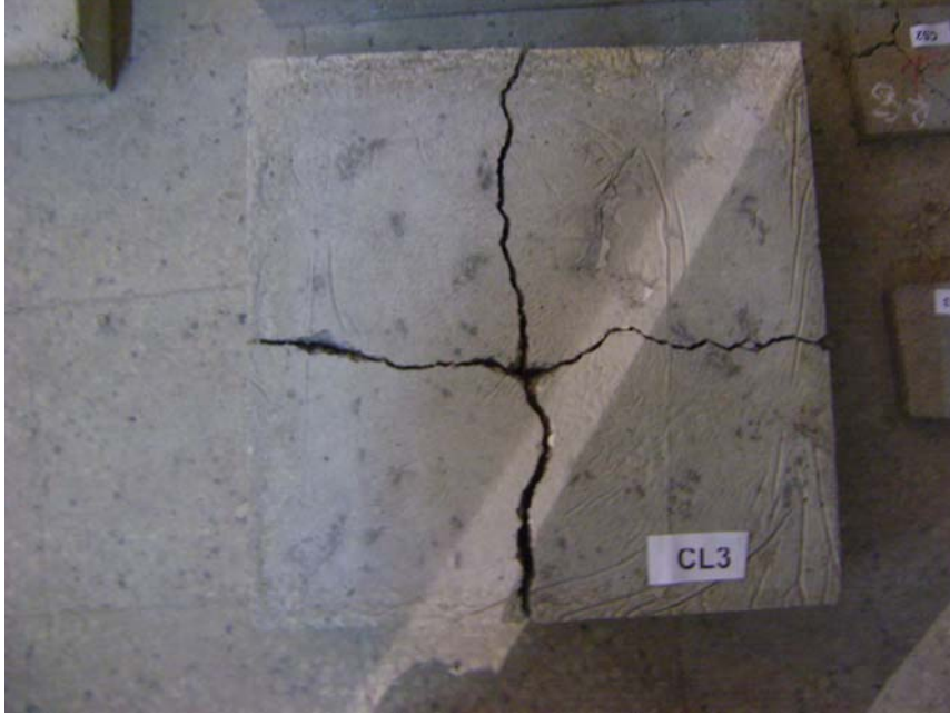
Őekil 3.3. CL 3 numunesinin atlak dađılımı
