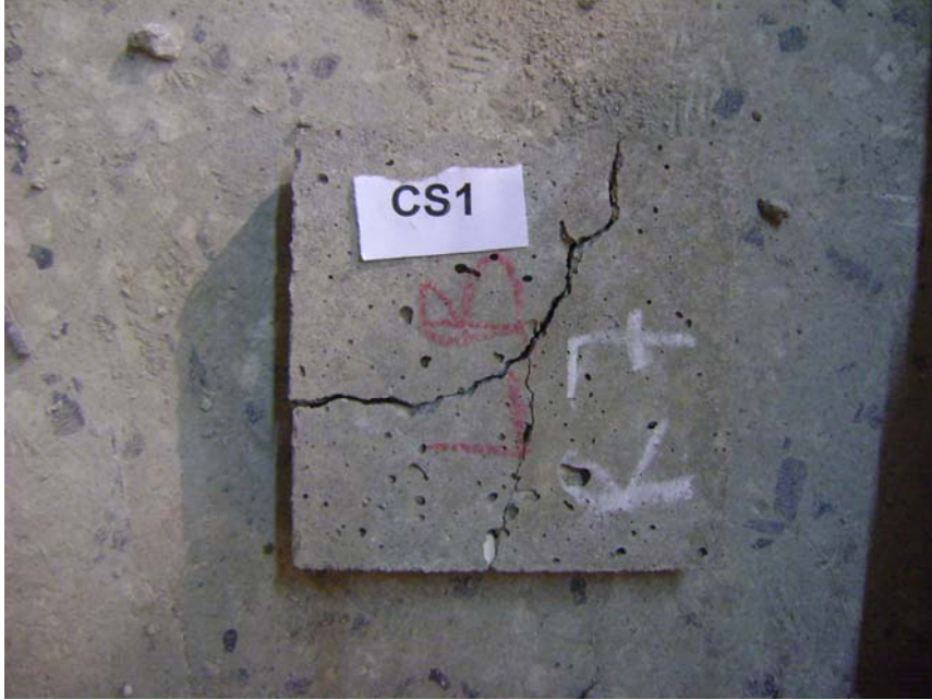
Şekil 3.7. CS 1 numunesinin atlak dađılımı
