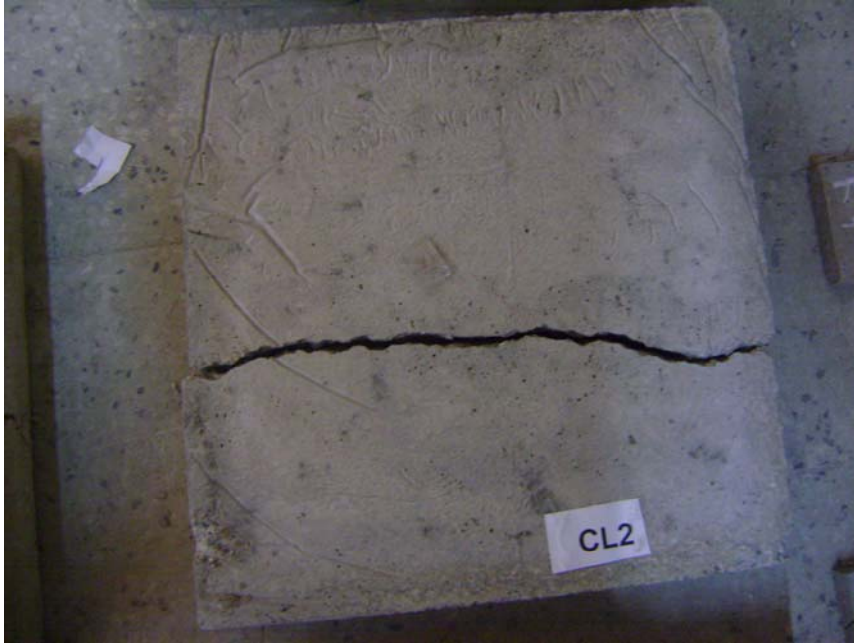
Şekil 3.2. CL 2 numunesinin çatlak dağılımı
