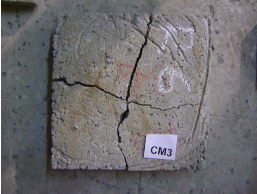
Şekil 3.6. CM 3 numunesinin atlak dađılımı
