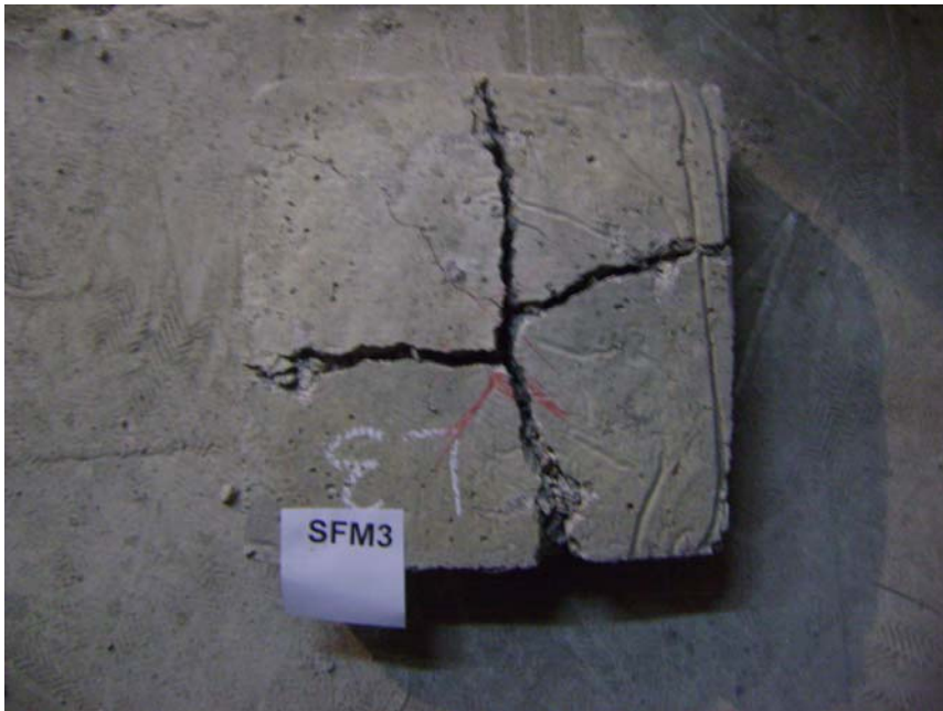
Őekil 3.22. SFM 3 numunesinin atlak dađılımı
