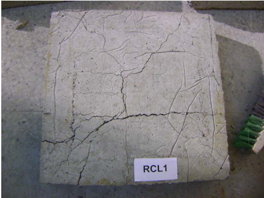
Őekil 3.10. RCL 1 numunesinin atlak dađılımları
