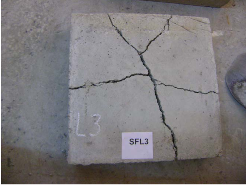
Şekil 3.19. SFL 3 numunesinin atlak dađılları
