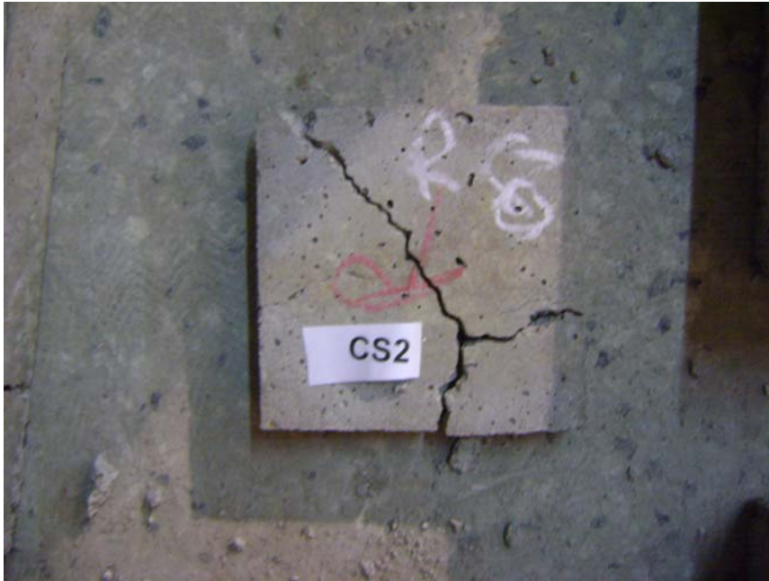
Şekil 3.8. CS 2 numunesinin atlak dađılımı
