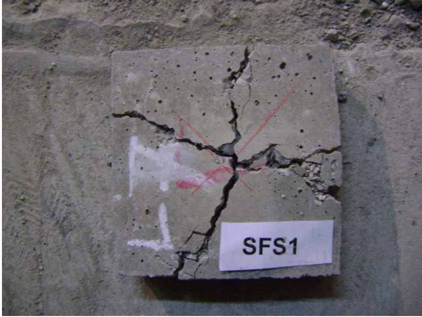
Şekil 3.27. SFS 1 numunesinin atlak dađılımı
