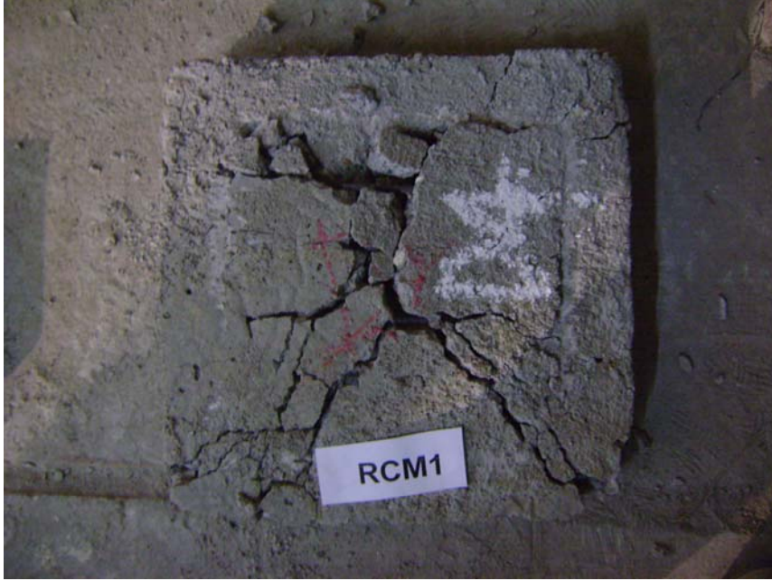
Őekil 3.13. RCM 1 numunesinin atlak dađılımı
