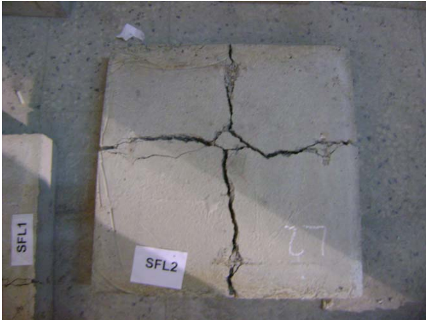
Şekil 3.20. SFL 2 numunesinin atlak dađılları
