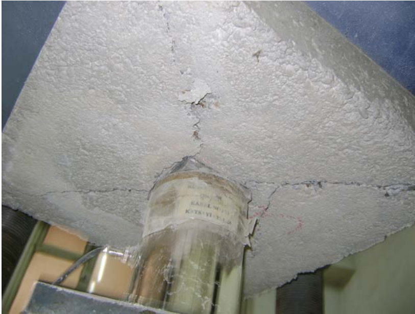
Resim 3.10. RCL3 döşemesinin göçme modu
