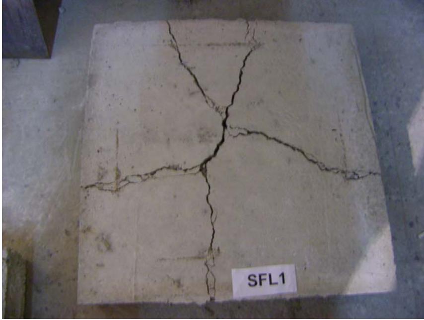
Őekil 3.21. SFL 1 numunesinin atlak dađılımı
