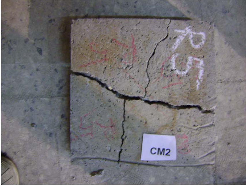
Şekil 3.5. CM 2 numunesinin atlak dađılımı
