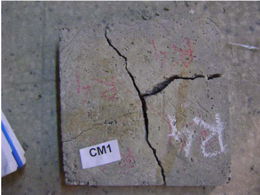
Őekil 3.4. CM 1 numunesinin atlak dađılımı
