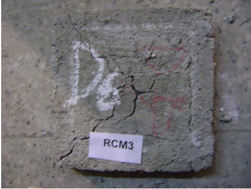
Şekil 3.15. RCM 3 numunesinin atlak dađılımları
