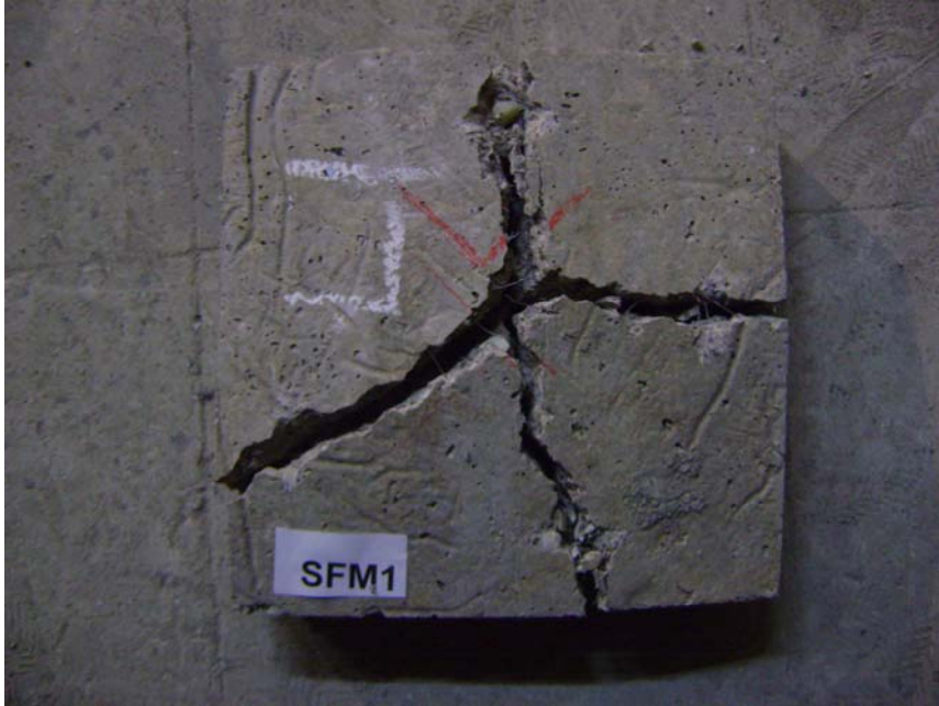
Şekil 3.24. SFM 1 numunesinin atlak dađılımı
