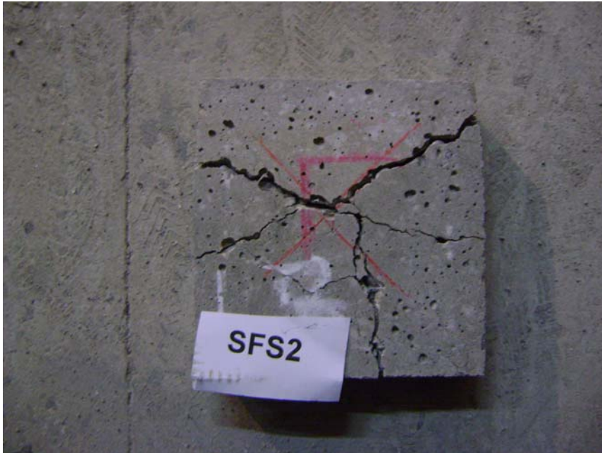
Őekil 3.26. SFS 2 numunesinin atlak dađılımları
