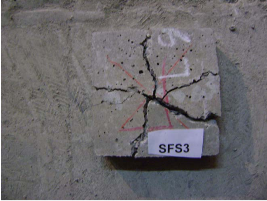
Őekil 3.25. SFS 3 numunesinin atlak dađılımları
