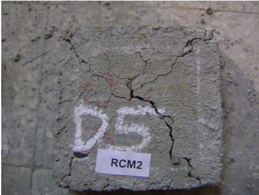
Őekil 3.14. RCM 2 numunesinin atlak dađılımı
