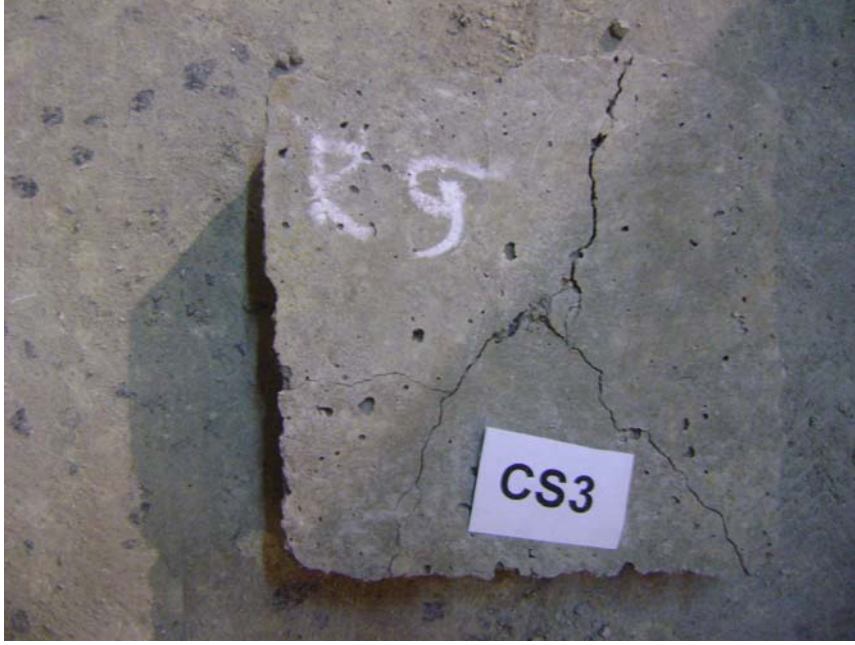
Őekil 3.9. CS 3 numunesinin atlak dađılımları
