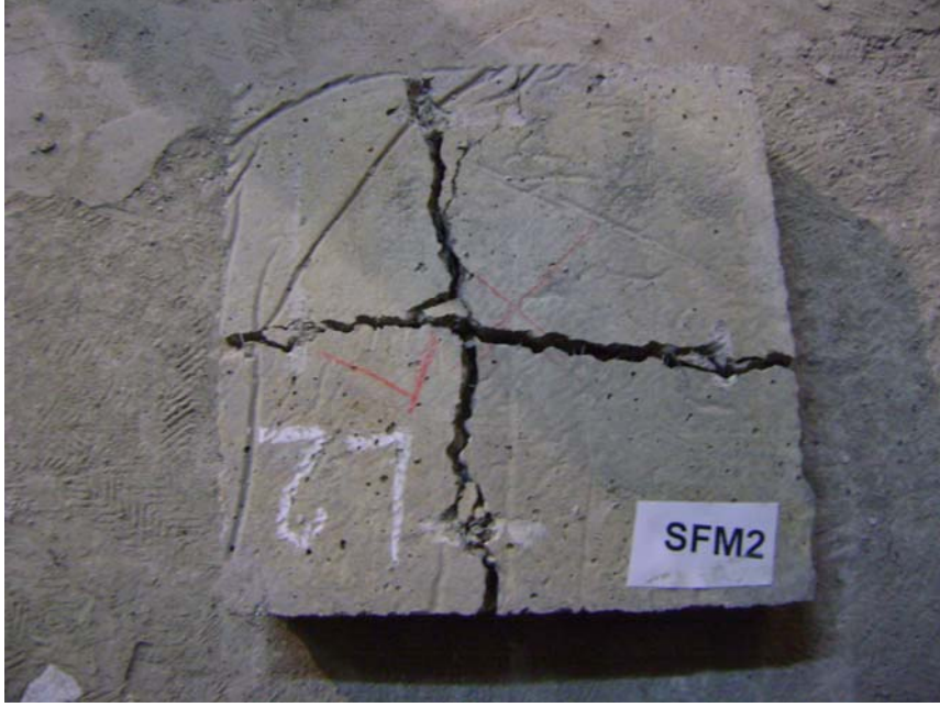
Şekil 3.23. SFM 2 numunesinin atlak dađılımı
