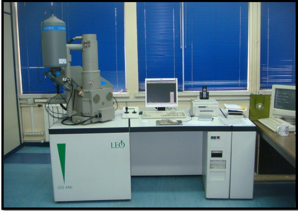
Resim 2.19 Flor analizinin yapıldığı SEM-WDS cihazı
