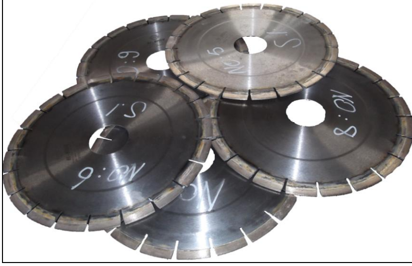
Şekil 10.12. Tamamlanmış elmaslı testereler
