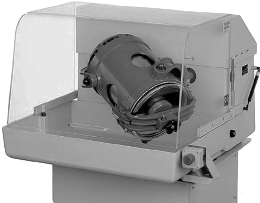
Şekil 10.2. Toz karıştırma mikseri (Turbula)
