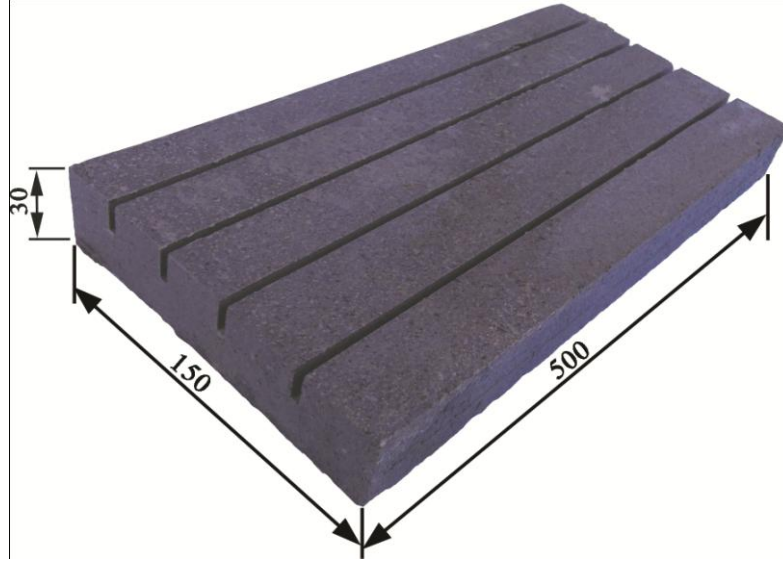
Şekil 10.15. Kesilen andezit taşının görünümü
