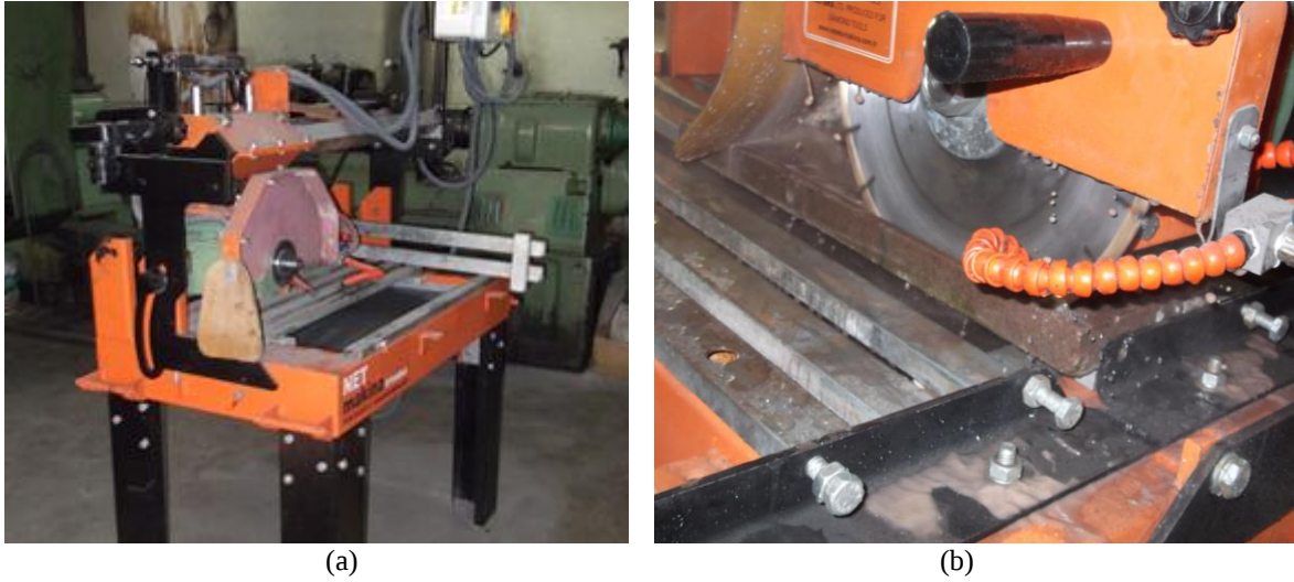
Şekil 10.14. (a) Doğal taş kesme makinesi ve (b) kesme işlemi
