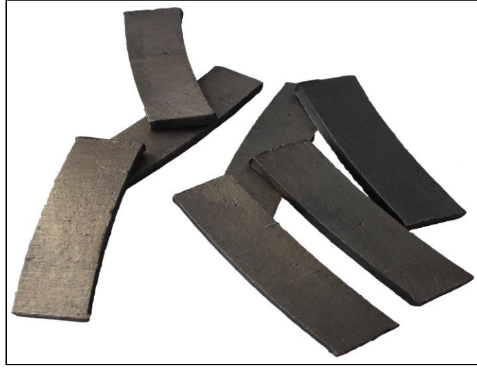
Şekil 10.7. Sıcak preste üretilmiş soketler
