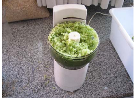
Şekil 3.8: Parçalanmak üzere hazırlanmış tatlı sorgum sapları ve parçalama işlemi
