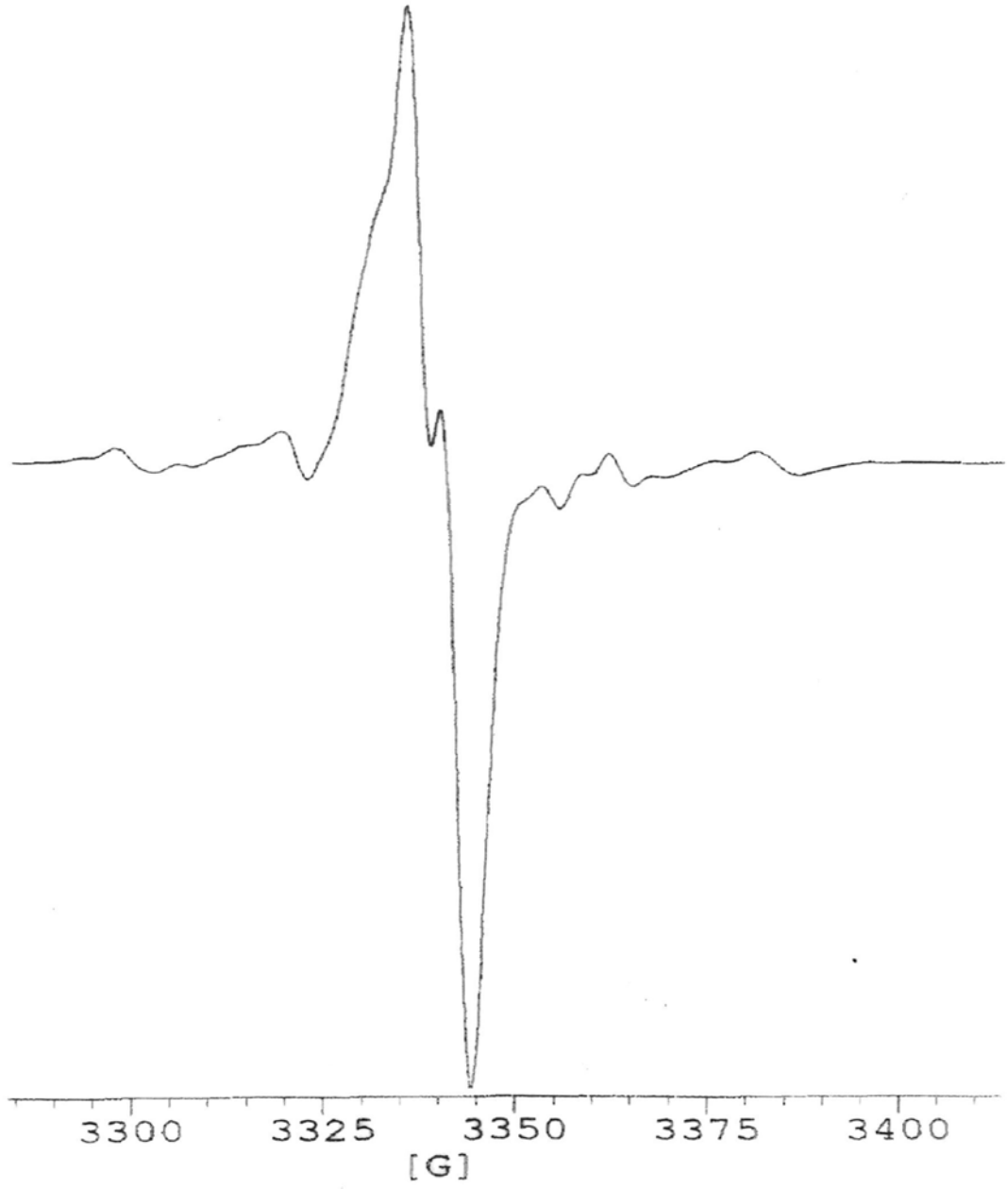
Şekil 4.29 Ethan-2,4-disulfonsaure Dinatrium Salz Dihydrate Tek Kristalinin 120° de ve 300 K'deki spektrumu
