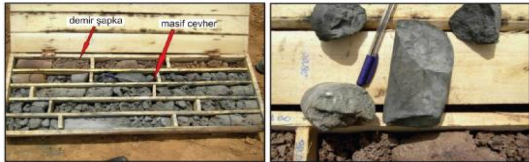
Şekil 4.43. AS-9 no.lu sondajda kesilen (a) demir şapka, (b) devamında yer yer ezik masif cevherlerin görünümü
