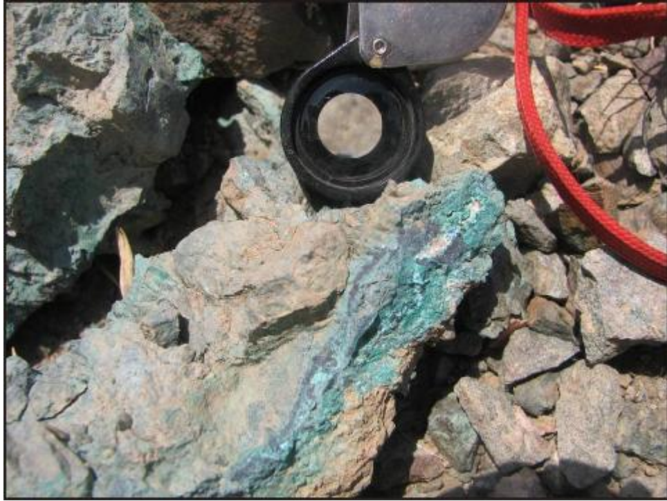
Şekil 4.72. Kırık zonuna yerleşmiş kalkozin-kovellin ve ikincil malahit
