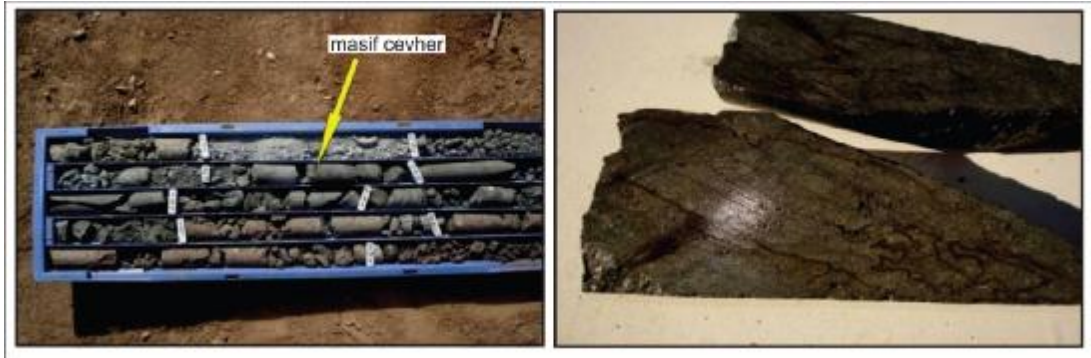
Şekil 4.42. AS-2 no.lu sondajda kesilen (a) masif cevher, (b) yarılanmış bu cevherin yakın görünümü
