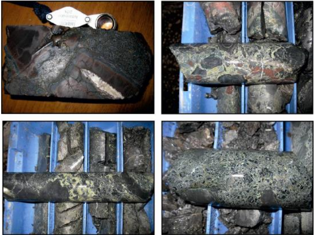
Şekil 4.56. Havşa dere stockwork zonda gelişmiş hidrotermal breş dokularından görünüm
