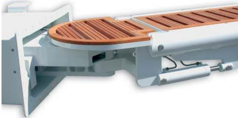
Şekil 1.11. Döner tip kasalı pasarellanın dönüş mekanizması (İlyas Genç, 2007)
