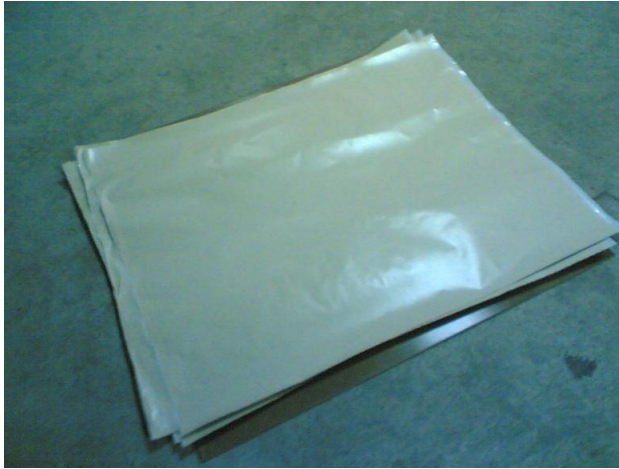
Şekil 5.4. Alüminyum iskelete sarmak üzere kesilmiş prepreg tabakaları
