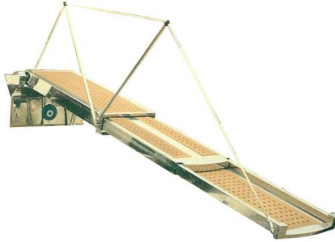
Şekil 1.4. Montajlı 3 kademeli teleskopik tip pasarellanın açık hali (Ezbercimarine)
