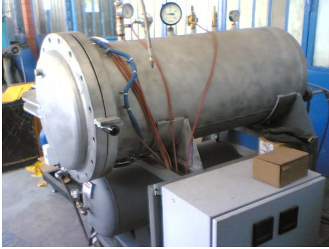
Şekil 5.11. Üretilen sıcaklık ve basınç kontrollü otoklavın son hali
