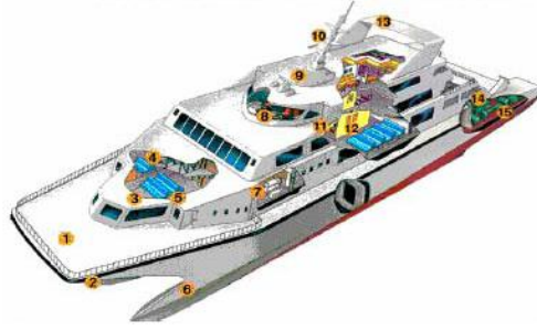
(c) 2. ve 6. Gövde dış kısmı, 4. Asma tavanlar, 7. Kamara bölmeleri, 9. Hava kalkanı: Petek yapılı kompoziti
