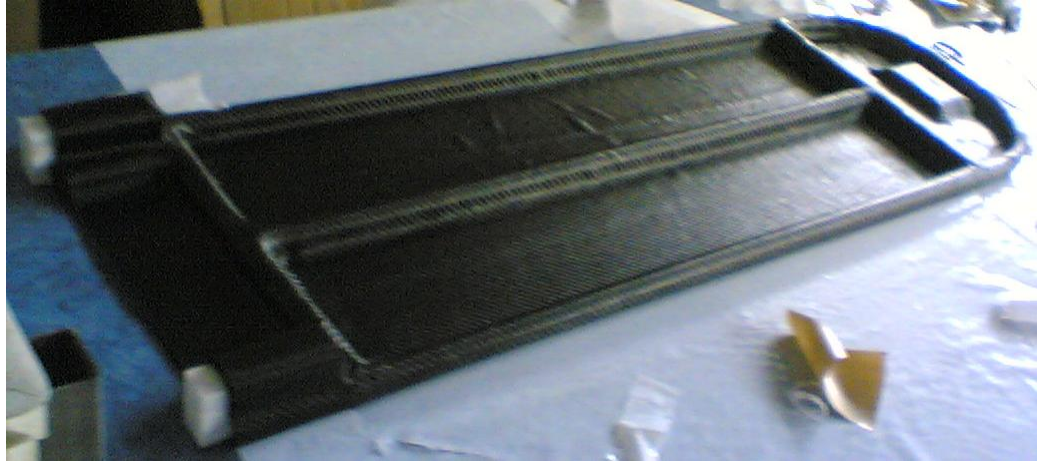
Şekil 5.6. Prepreg tabakaların alüminyum iskelete sarılı hali
