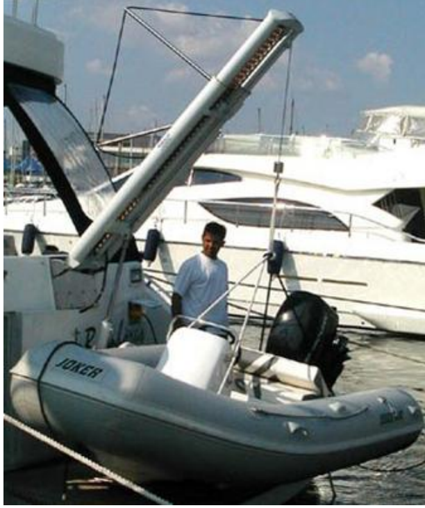
Şekil 1.12. Yük kaldırmada kullanılan pasarella (İlyas Genç, 2007)
