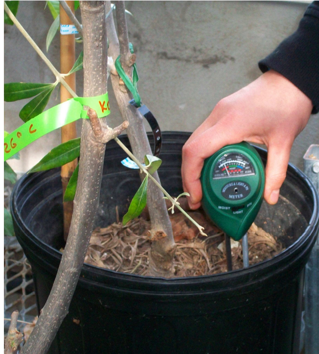
Şekil 3.4: Toprak nem ölçer aparatı
