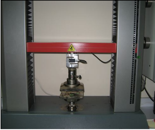
Şekil 3.12. Zwick Universal test makinesinde liflere dik basınç direncinin belirlenmesi
