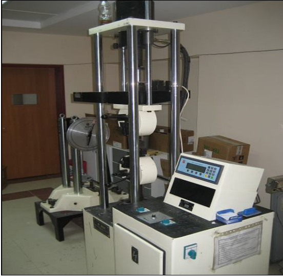
Şekil 3.11. Liflere paralel basınç direncini belirlemek için kullanılan test makinesi
