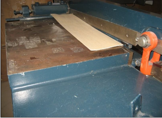
Şekil 3.2. Kaplama levhaların giyotinde kesilmesi
