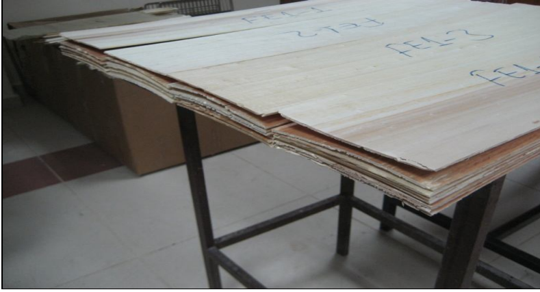
Şekil 3.4. Tutkal sürülen kaplamaların taslak haline getirilmesi
