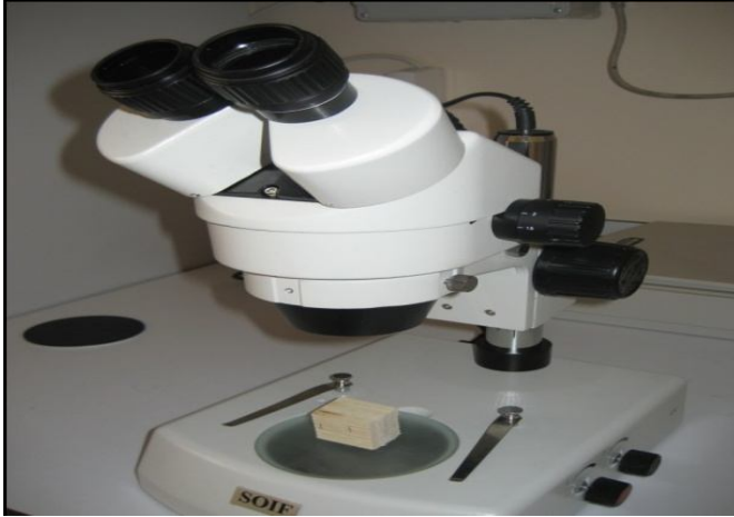
Şekil 3.6. Örnek ölçümü için kullanılan binoküler stereo zoom mikroskop
