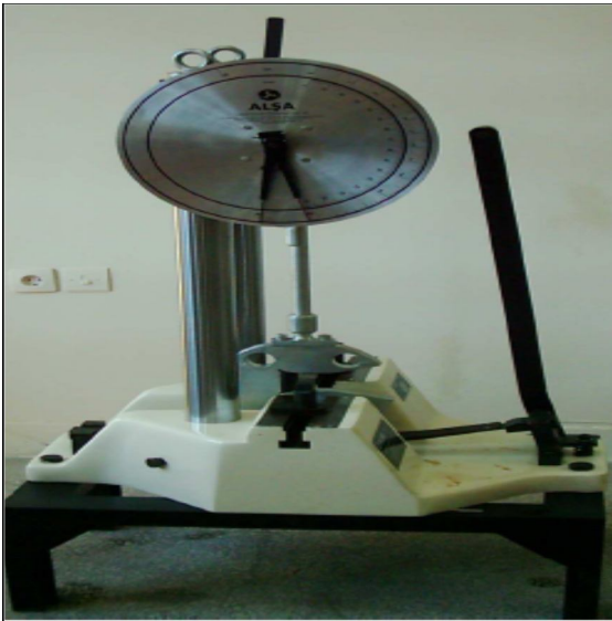
Şekil 3.14. Dinamik eğilme (şok) direnci test makinesi
