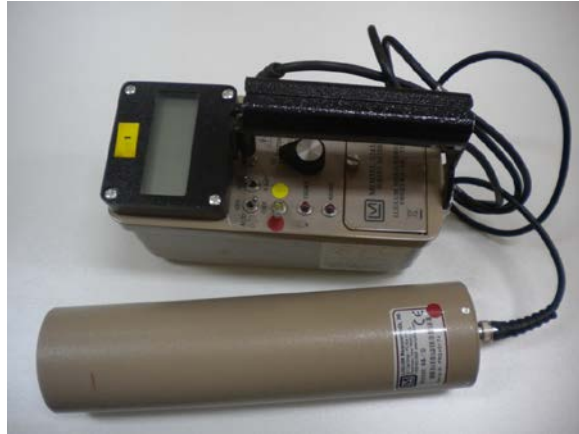
Şekil 3.3 : 44-10 model NaI(Tl) gama sintilasyon dedektörüne bağlı Ludlum marka 2242-2 model taşınabilir dijital cihaz
