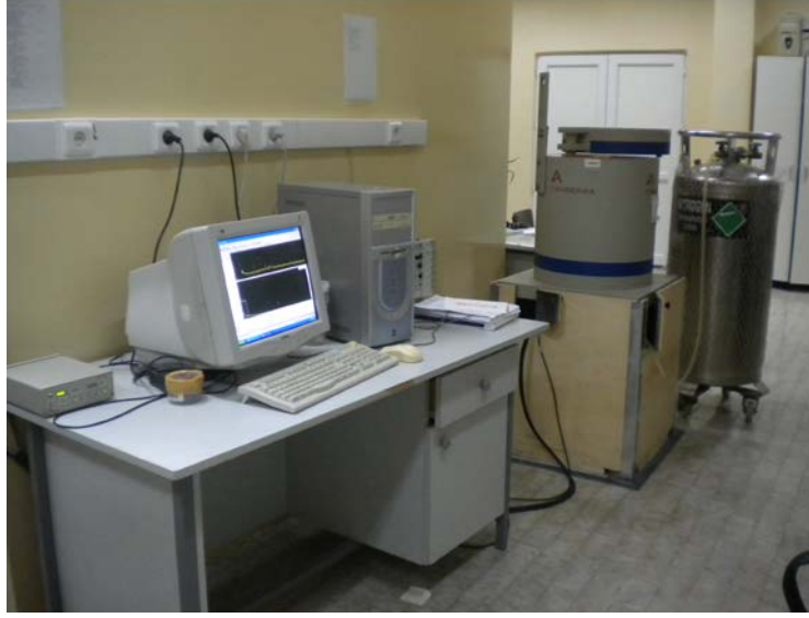
Şekil 3.6 : Gama spektrometrik analiz sistemi düzeneği (ÇNAEM Radyoaktivite Ölçme ve Analiz Birimi Laboratuvarı)
