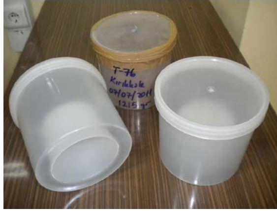
Şekil 3.4: Boş marinelli kap ile içerisinde toprak örneği bulunan ağzı bantla kapatılmış dolu bir marinelli kap
