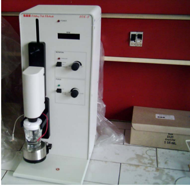
Şekil 3.2 Döner disk elektrot çalışmalarının yapıldığı deney düzeneği
