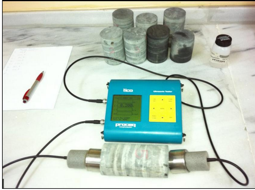
Şekil 3.15: Ultrasonik ses geçirgenliği deney düzeneği
