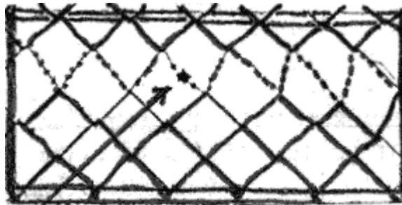
GTR korozyona uğrayarak kaçış panelini serbest bırakır
