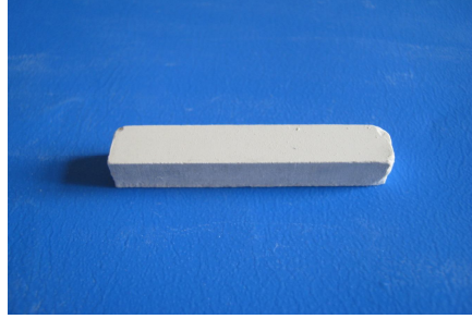
Şekil 5.24. Hidrolik pres kullanılarak şekillendirilmiş pirofillit numunesi
