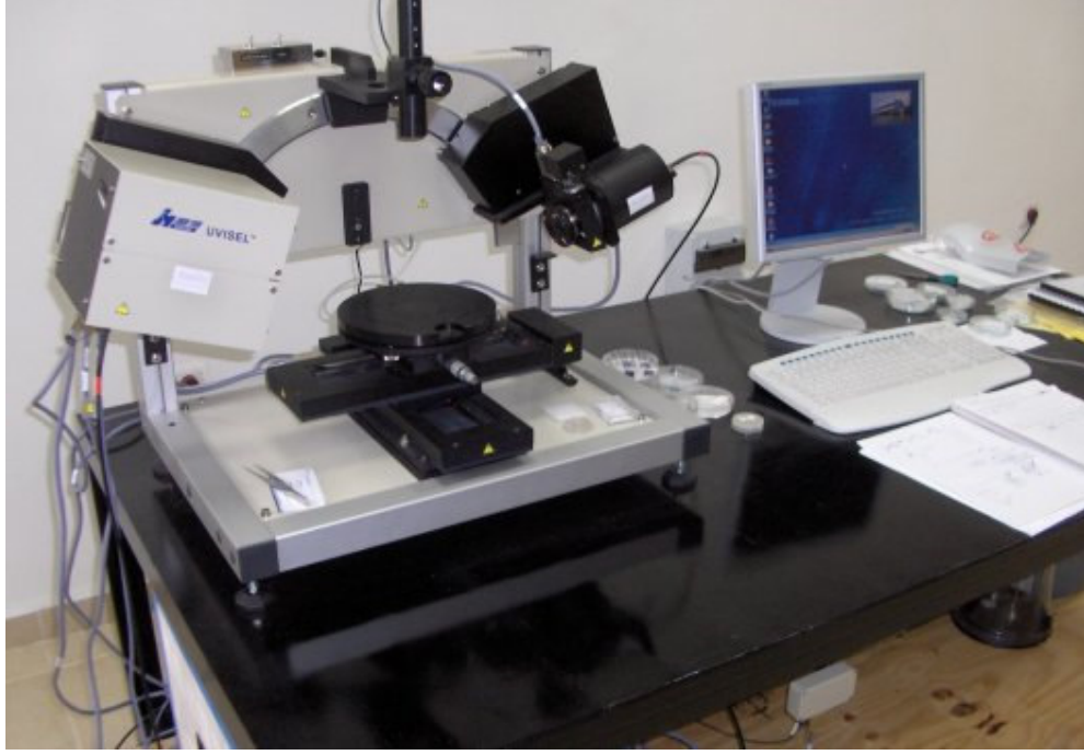
Resim 3.6. Deneyler sırasında kullandığımız spektroskopik elipsometre.
