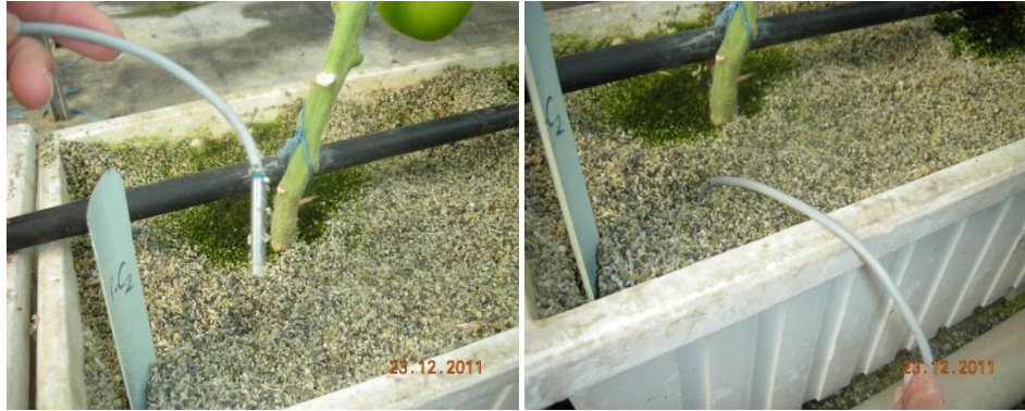
Şekil 3.9 Sera ve substrat sıcaklığını, oransal nem değerlerini kaydeden sensörler.
