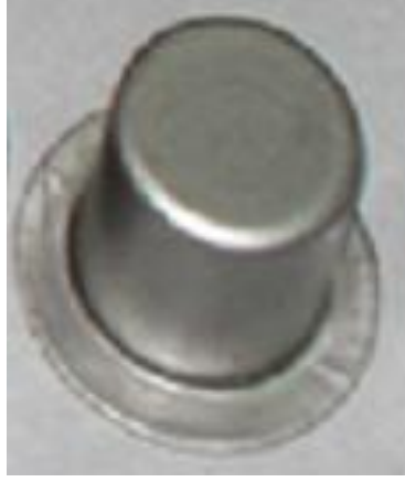
Şekil 7.14. Progresif Derin Çekme ile Elde Edilmiş Ürün
