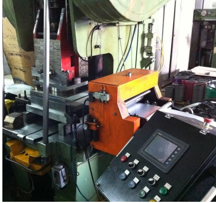
Şekil 7.15. Deney parçasının imal edildiği PLC kontrol, kalıp ve pres Sistemi çalışması
