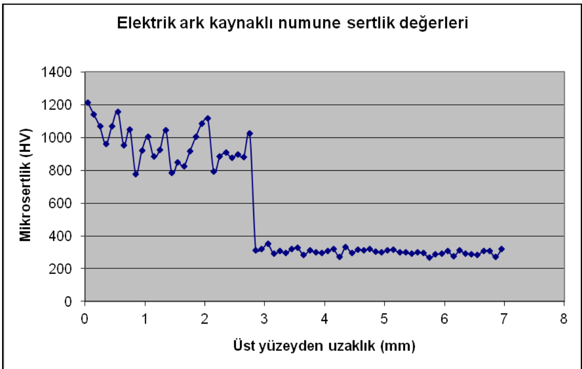
Şekil 7.1 Sertlik ölçüm deneylerinin üst yüzeyden derinliğini gösteren grafik.
