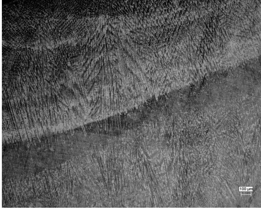
Şekil 7.5 Elektrik ark kaynağı kullanılarak Citodur 600 elektrotuyla kaplanan AISI 1030 çeliğinin mikroyapı görüntüsü (X50) büyütmede.
