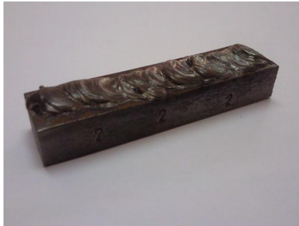
Şekil 6.2 Elektrik ark kaynak yöntemi kullanılarak Citodur 600 elektrotla kaplanan orta karbonlu alaşımsız AISI 1030 çelik numune.
