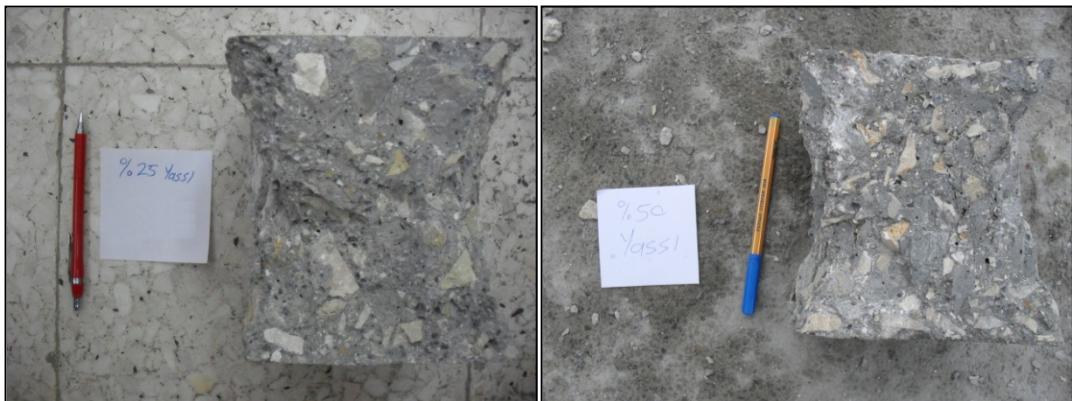
Şekil 39. Seri 3 (%25 yassı) ve Seri 4 (%50 yassı) örneklerinin beton presinde kırılmış durumları
