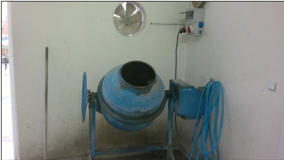
Şekil 28. Beton üretiminde kullanılan mikser
