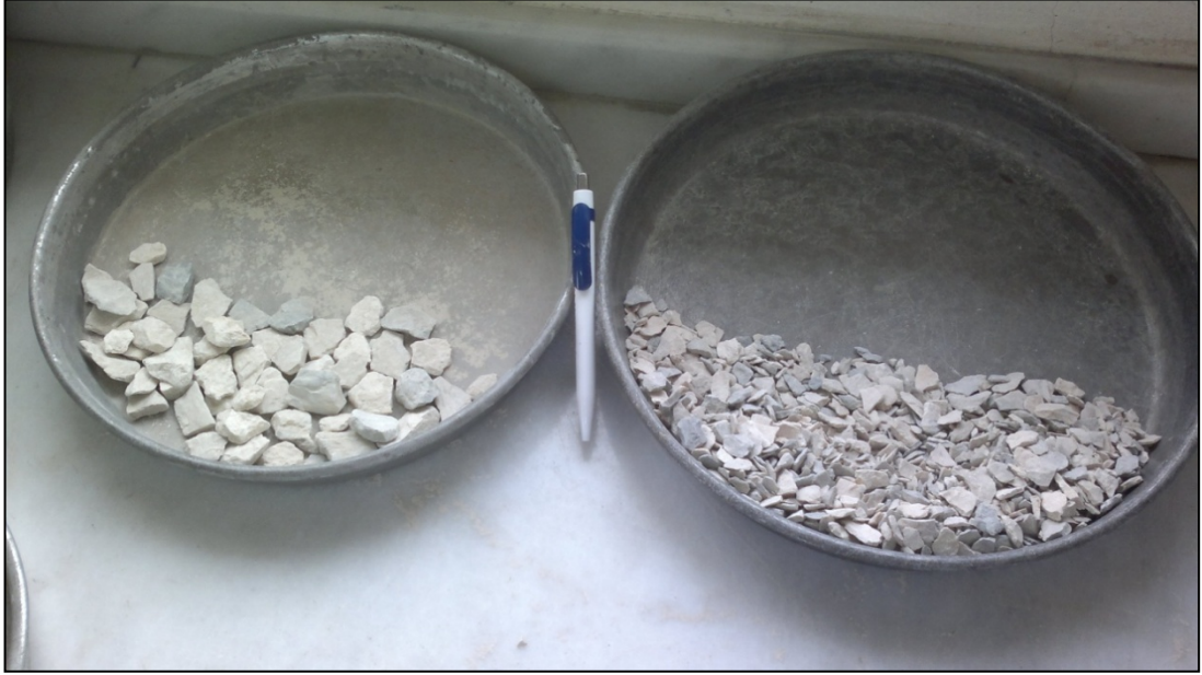
Őekil 26. Boyutları 11,2-22,4 mm ve 4-11,2 mm olan yassı agregalar
