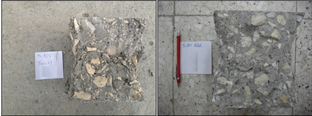
Şekil 40. Seri 5 (%100 yassı) ve Seri 1 (% 0 yassı) örneklerinin beton presinde kırılmış durumları
