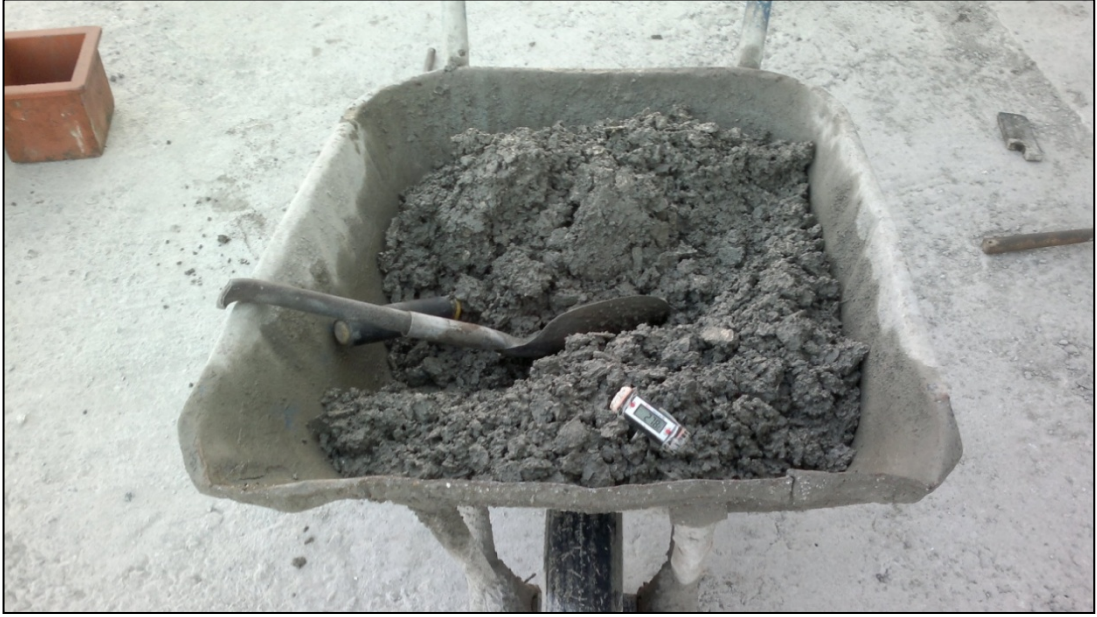
Őekil 31. Üretilen beton örneklerinin sıcaklık değeri
