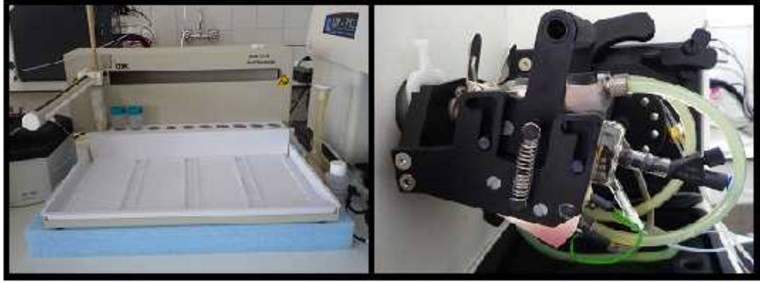
Şekil 17. Sıvı örnekler için ICP-MS girişi. Solda otomatik örnekleyici, sağda nebulizatör ve püskürtme haznesi
