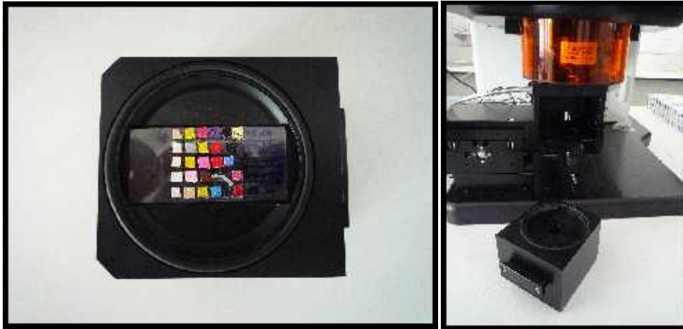
Şekil 18. 0.5 cmx 0.5 cm büyüklüğündeki örneklerin lazer aşındırma haznesine yerleştirilmesi (solda) ve lazer aşındırma cihazının vakum hücresi (sağda)
