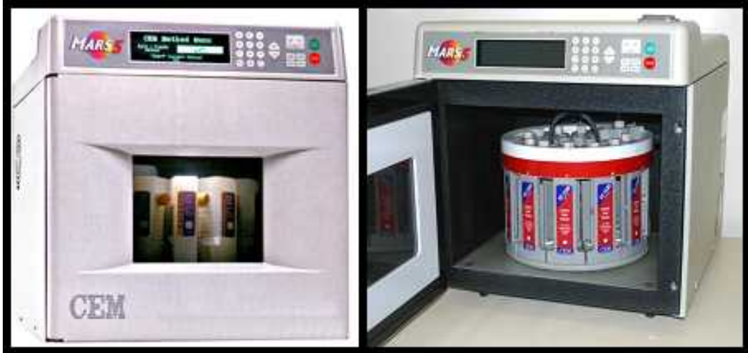
Şekil 10. CEM Mars 5 Mikrodalga yaş yakma sistemi [i.45, i.46]
