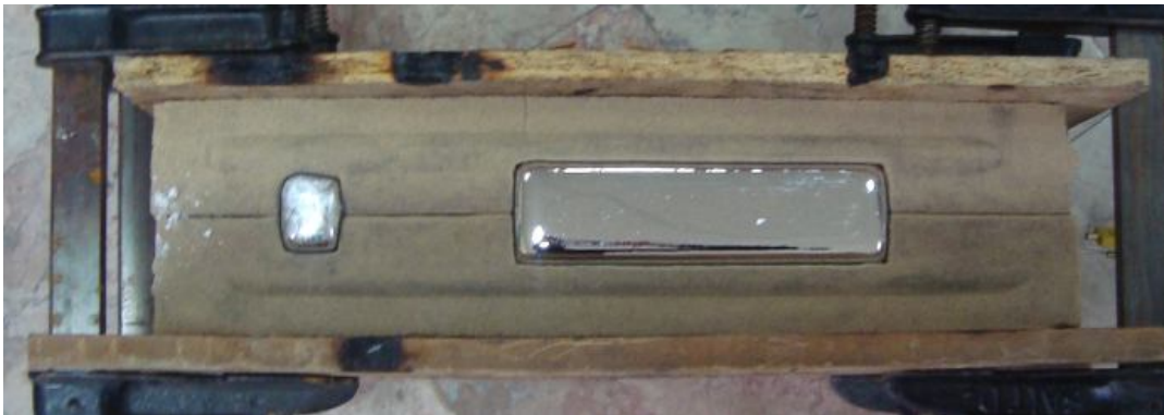
Şekil 3.23. Türbülanssız dökülmüş parçanın katılaşmadan önceki resmi.
