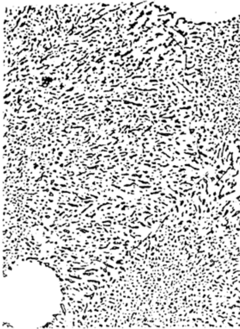
Şekil 2.6. %12 Si ve %0.3 Fe'li modifiye edilmemiş alaşım. Kum döküm X250 (Mondolfo, 1979)
