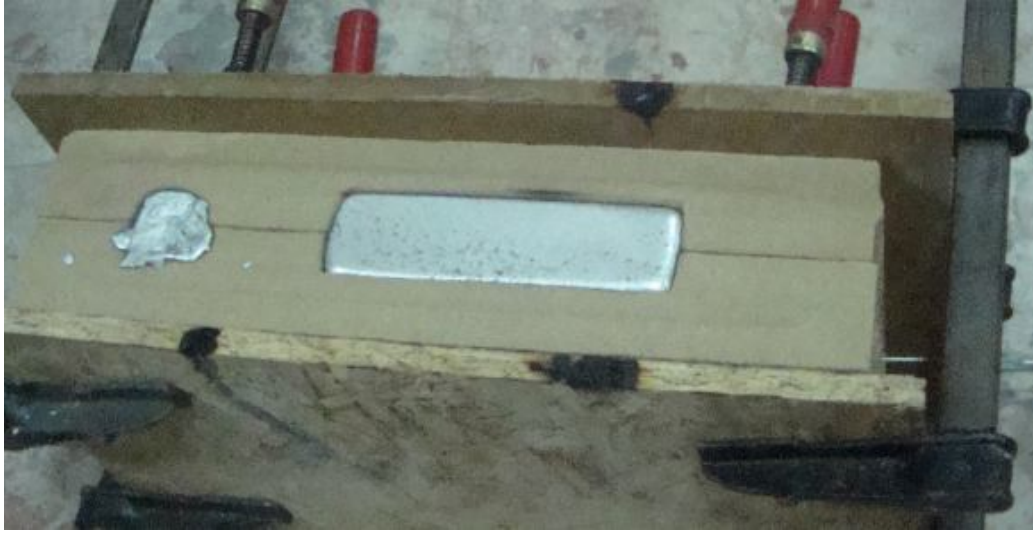
Şekil 3.24. Türbülanslı döküm parçasının katılaşıma başladığı an.
