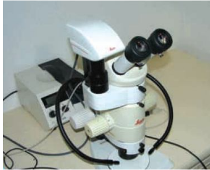
Şekil 3.17. Makro porozite ölçümünde kullanılan mikroskop ve kamera.
