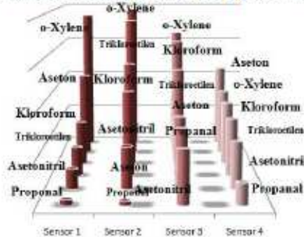
Şekil.2 4 Farklı sensör tipi ile 6 farklı uçucu organik bileşen için alınan deneysel sonuçlar
