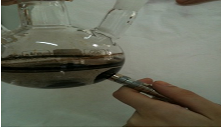
Şekil 3.4 Mıknatıs yardımıyla çöktürme işlemi
