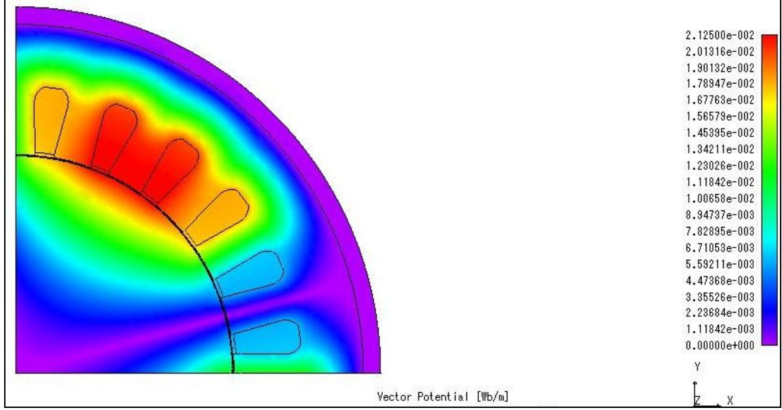
Şekil 4.5. Magnetik vektör potansiyelinin başlangıç durumundaki ( t=0 ) gösterimi
